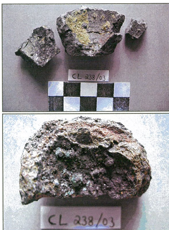
Fig. 8 - Cadinhos de fundição onde se verifica a presença de produtos de alteração característicos do cobre e suas ligas.
