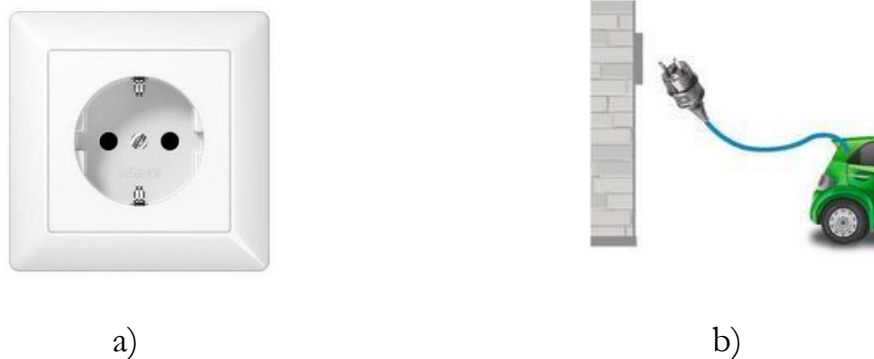
Figura 3.5-1 – Modo 1: a) tomada doméstica (Schuko); b) exemplificação do modo de carregamento 1 (MIDA EVSE)
