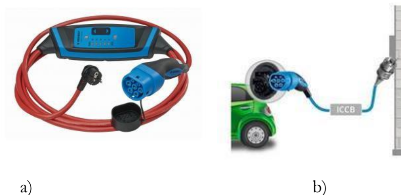
Figura 3.5-2 – Modo 2: a) Cabo com uma extremidade para tomada doméstica (Schuko), uma tomada do Tipo 2 Mennekes do lado de ligação ao carro e uma caixa de controlo eletrónico integrado no meio do cabo; b) exemplificação do modo carregamento 2 (MIDA EVSE)
