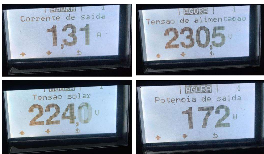
Figura 6.39 Parâmetros elétricos da instalação
