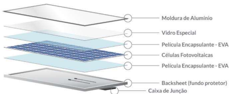
Figura 4.17 Composição de um módulo fotovoltaico (Solar, s.d.)
