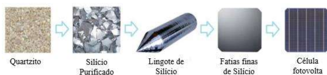
Figura 4.8 Etapas de fabricação das células (Svarc, Jason, 2020)
