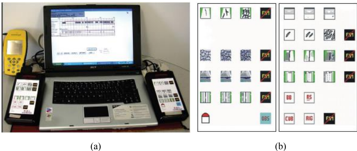
Figura 2.13 – a) Sistema informático VIZIROAD e teclados de apoio b) Aspectos dos teclados para registo das degradações (Santos L. d., S/D).
