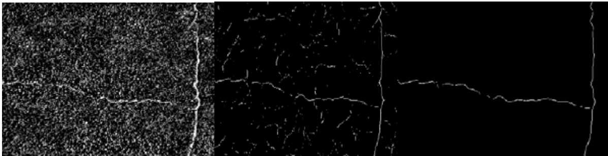
Figura 2.14 Método Crack-Tree - Para deteção automática de fendas (Zou, Cao, Li, Mao, & Wang, 2011).
