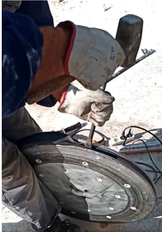
Figura 3 - Demonstração da colocação manual do perfil de borracha.
