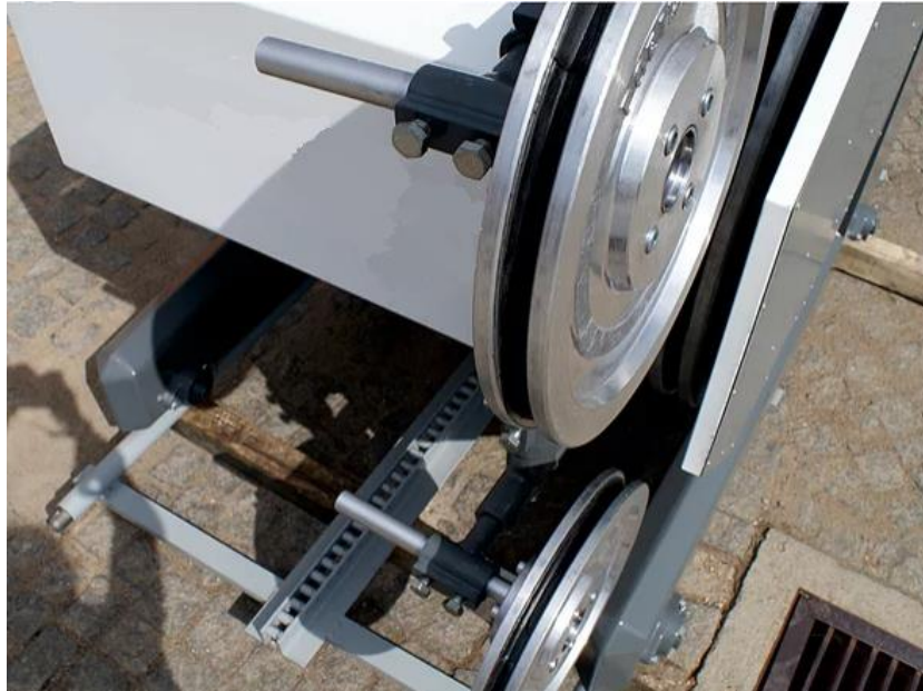
Figura 2 - Roda de tração de fio diamantado com perfil de borracha. [2]
