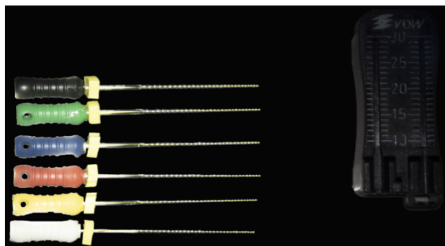
Figura 51 - Imagem ilustrativa de como foi medido o comprimento da haste metálica de cada lima analisada.
