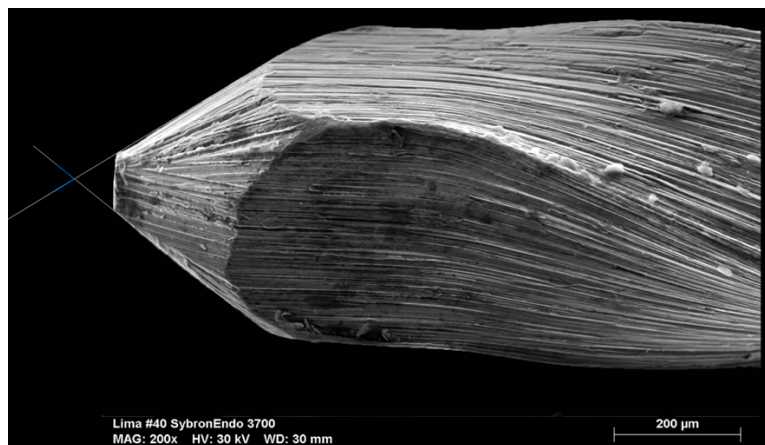
Figura 70 - Exemplo da medição do ângulo da ponta da lima #40 da SybronEndo.
