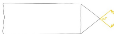
Figura 7 - Figura ilustrativa da forma e do ângulo da ponta dos instrumentos endodônticos do tipo 1.
