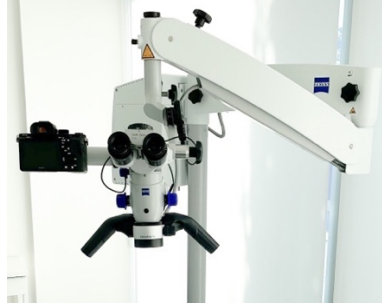
Figura 15 - Microscópio cirúrgico Zeiss OPMI Pico acoplado à câmara fotográfica Sony \alpha 7s II.
