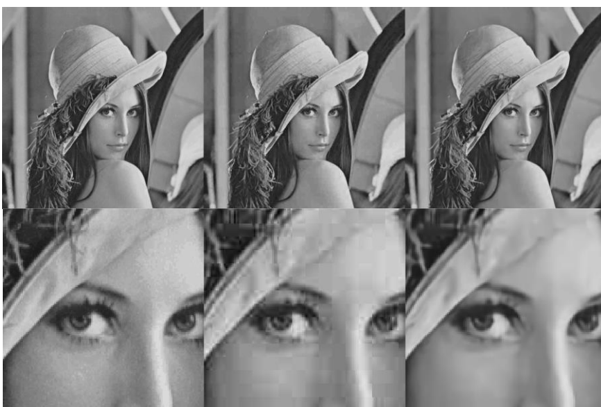
Figura 72 - Resultado do método usando apenas JPEG e JPEGnn (melhoramento do JPEG) (bpp = 0,3652). Da esquerda para a direita: input, JPEG (psnr = 35,32), JPEGnn (psnr = 36,67).
