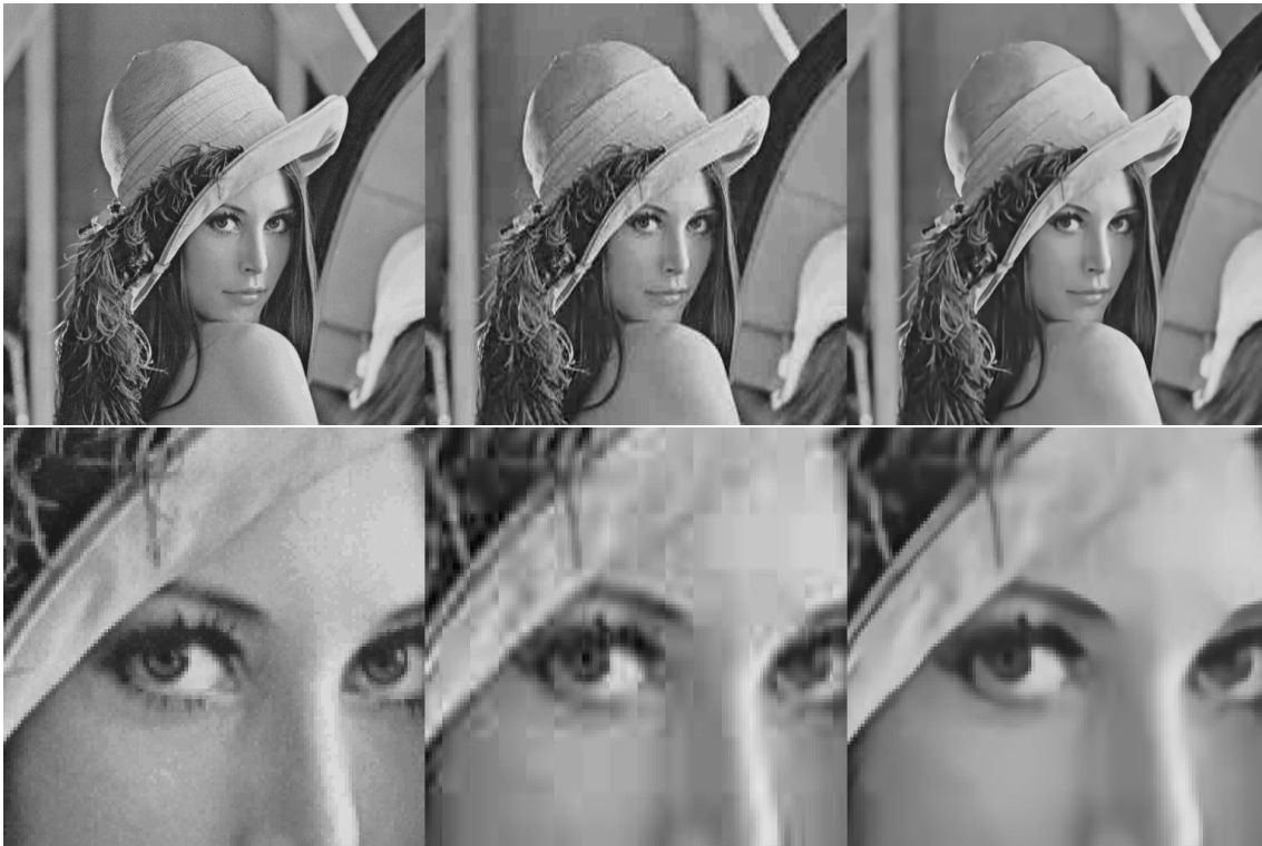
Figura 81 - Resultado do método usando 1 descrição (bpp = 0,04296. Da esquerda para a direita: input, pré-dncnn (psnr = 32,24 dB), output (psnr = 34,70 dB).
