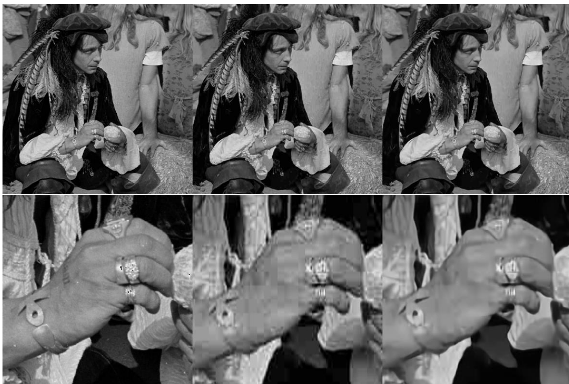
Figura 83 - Resultado do método usando 1 descrição (bpp = 0,4038). Da esquerda para a direita: input, pré-dncnn (psnr = 31,07 dB), output (psnr = 32,36 dB).
