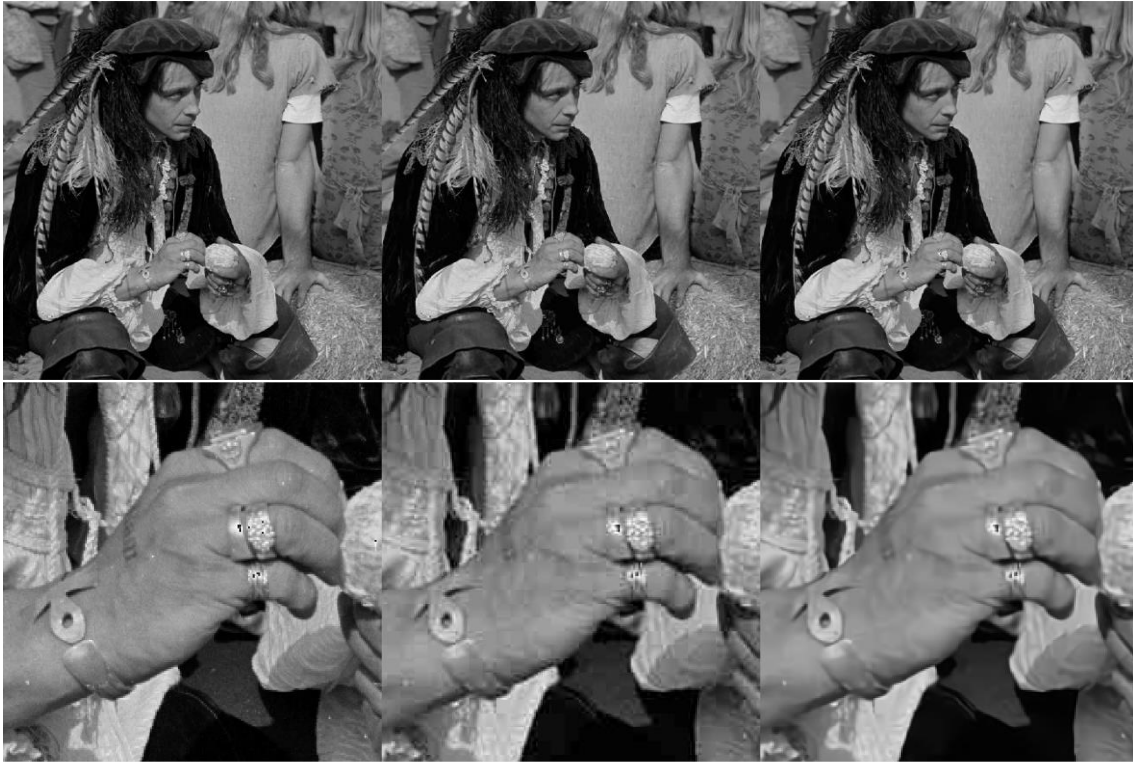
Figura 84 - Resultado do método de melhoramento do JPEG (JPEGnn) (bpp = 0,4245). Da esquerda para a direita: input, JPEG (psnr = 34,39 dB), JPEGnn (psnr = 35,50 dB).
