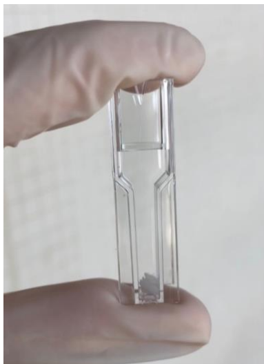
Figura 21- Cuvete com as 6 tiras de PerioPaper® Gengival Fluid Collection Strips, solução SA e NEDA, sem coloração.
