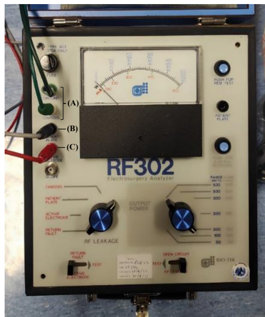
Figura 3.11. Equipamento de teste de DM's de eletrocirurgia. (A) Componente da massa; (B) Componente neutra; (C) Componente ativa. [Imagem captada pelo autor].
