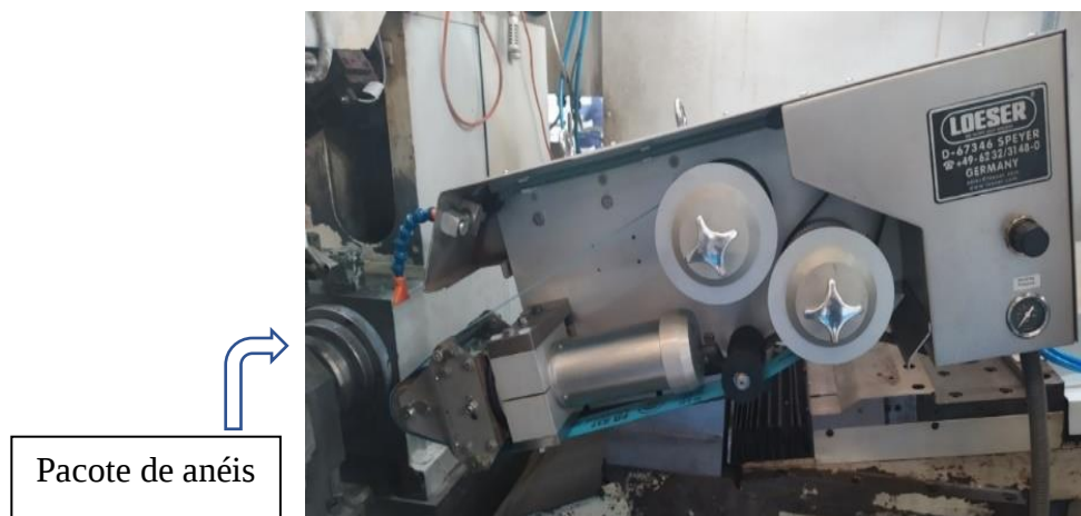
Figura 26- Cabeçote LOESER montado na RPF-03, onde irá ser efetuado o lixamento automático
