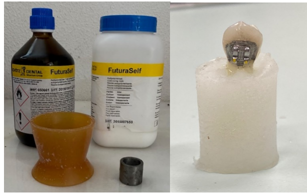
Figura 11 - Material para confecção dos blocos de acrílico e resultado final
