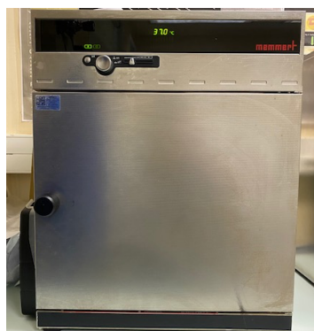
Figura 3 - Estufa incubadora universal Memmert® INE 4002.
