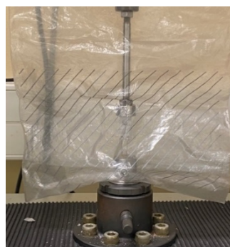
Figura 13 - Amostra preparada para iniciar teste protegida com saco transparente
