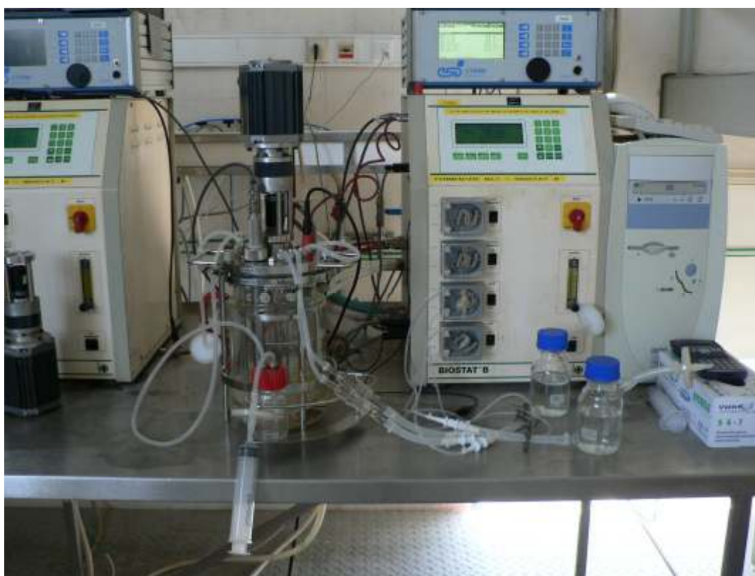
Figura 7. Fermentador Braun e sistema de controlo Biostat B
