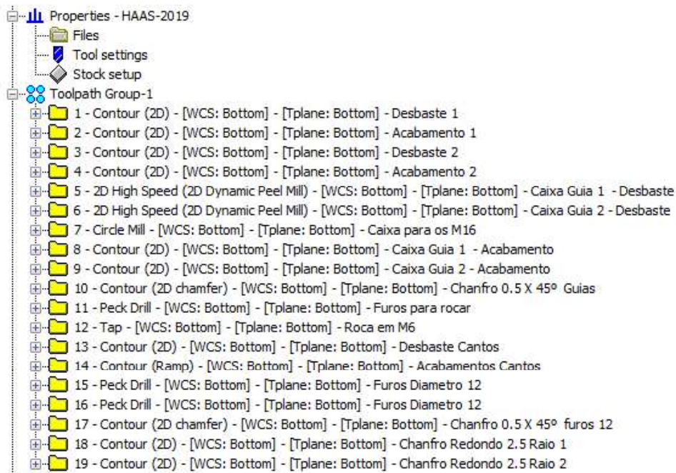
Figura 3.26 - Ciclos de maquinagem utilizados no 1º Aperto.
