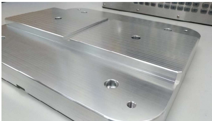
Figura 3.57 - Pormenor dos chanfros e do acabamento das superfícies.
