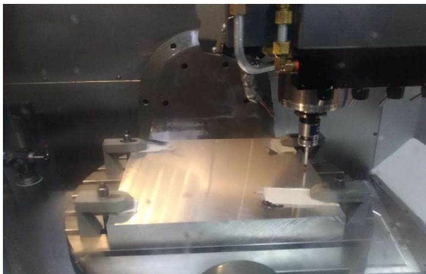
Figura 3.37 - Procedimento para o cálculo do Zero Peça com sonda Renishaw.
