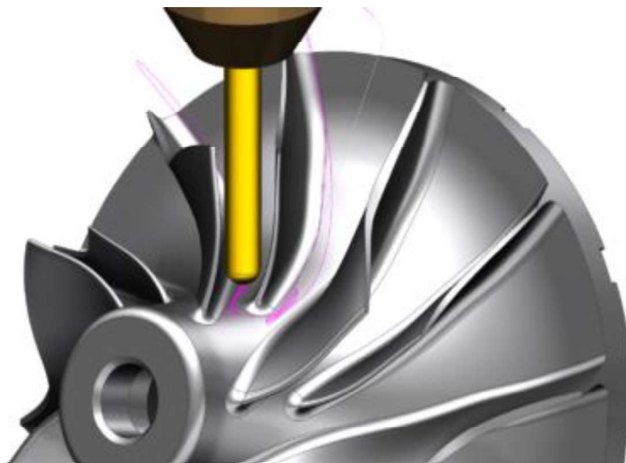
Figura 2.45 - Exemplo de maquinagem 5 Eixos executada com base no Solid Edge® CAM Pro . ( Solid Edge , 2019)
