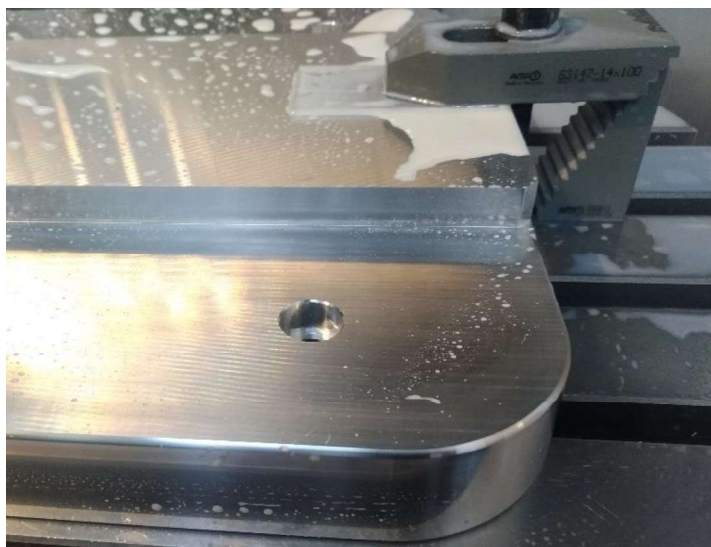
Figura 3.50 - Chanfro de 45° com 0.5 mm e boleado com raio de 2.5 mm.
