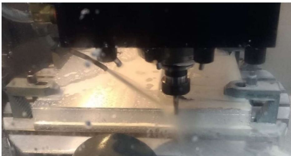
Figura 3.38 - Maquinagem das faces, ciclo nº2.
