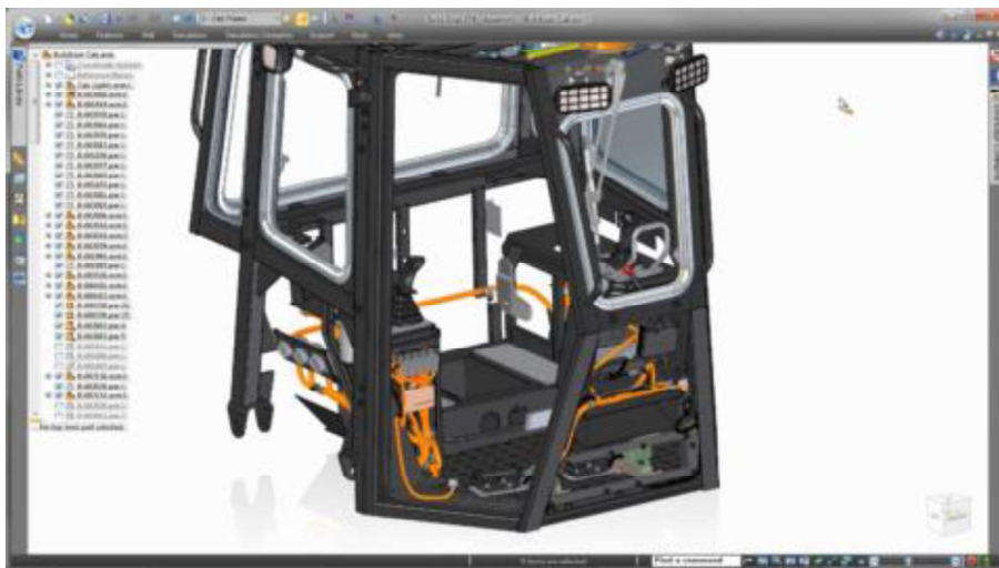
Figura 2.35 - Exemplo de aplicação das ferramentas Assembly Relationships . ( Solid Edge , 2019)
