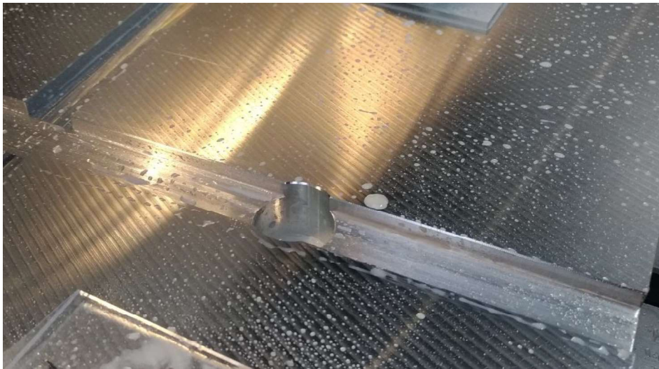
Figura 3.42 - Caixas para encaixe das guias, onde se encontram os chanfros realizados nas arestas interiores.
