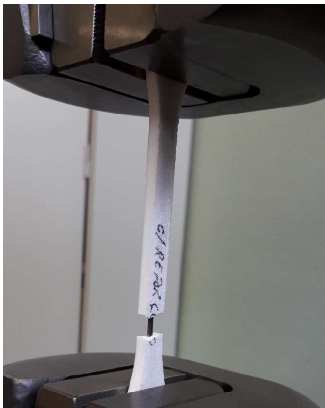
Figura 5.7 - Resultado visual do ensaio do provete com reforço
