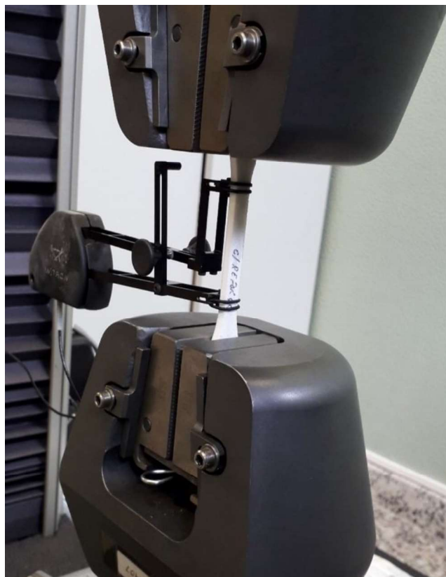
Figura 5.5 - Fixação dos provetes em PLA.
