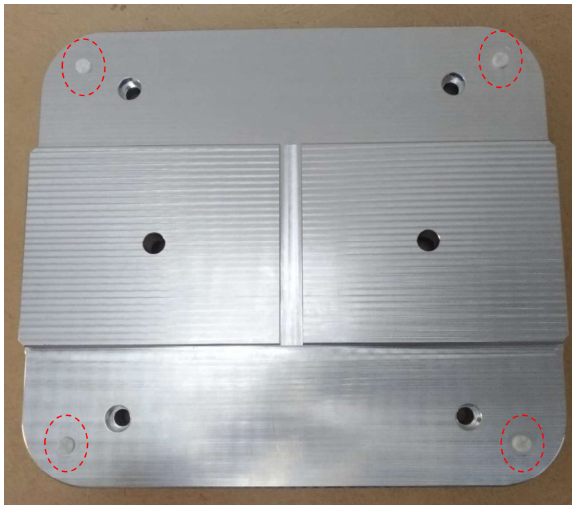
Figura 4.21 - Aplicação final das Tampas Roscadas M10.
