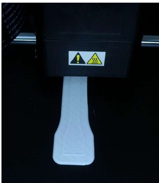
Figura 4.24 - Processo de impressão do provete.
