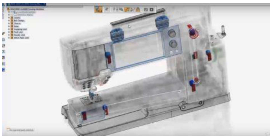
Figura 2.42 - Exemplo de aplicação do módulo Last Changes . (Solid Edge, 2019)
