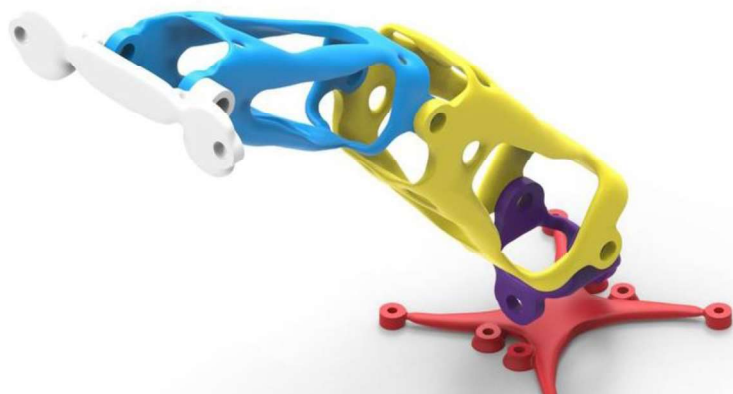
Figura 2.14 - Componente otimizado para impressão 3D. (Solid Edge, 2019)
