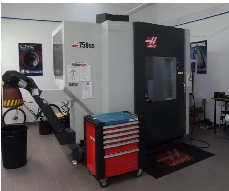
Figura 3.34 - Máquina utilizada, HAAS UMC 750SS.
