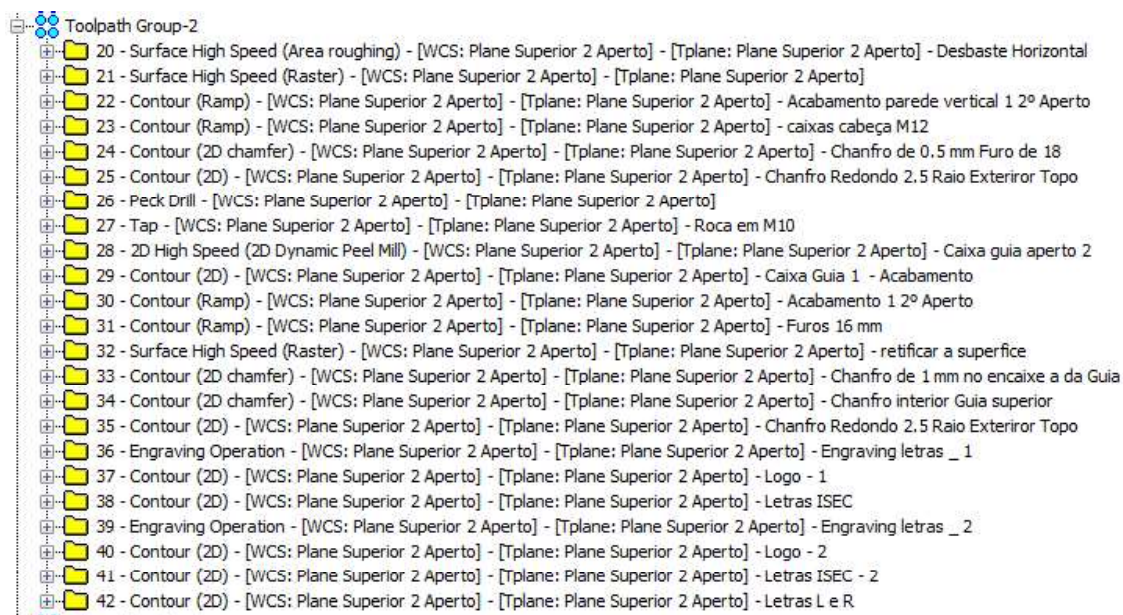
Figura 3.31 - Ciclos de maquinagem do 2º Aperto.
