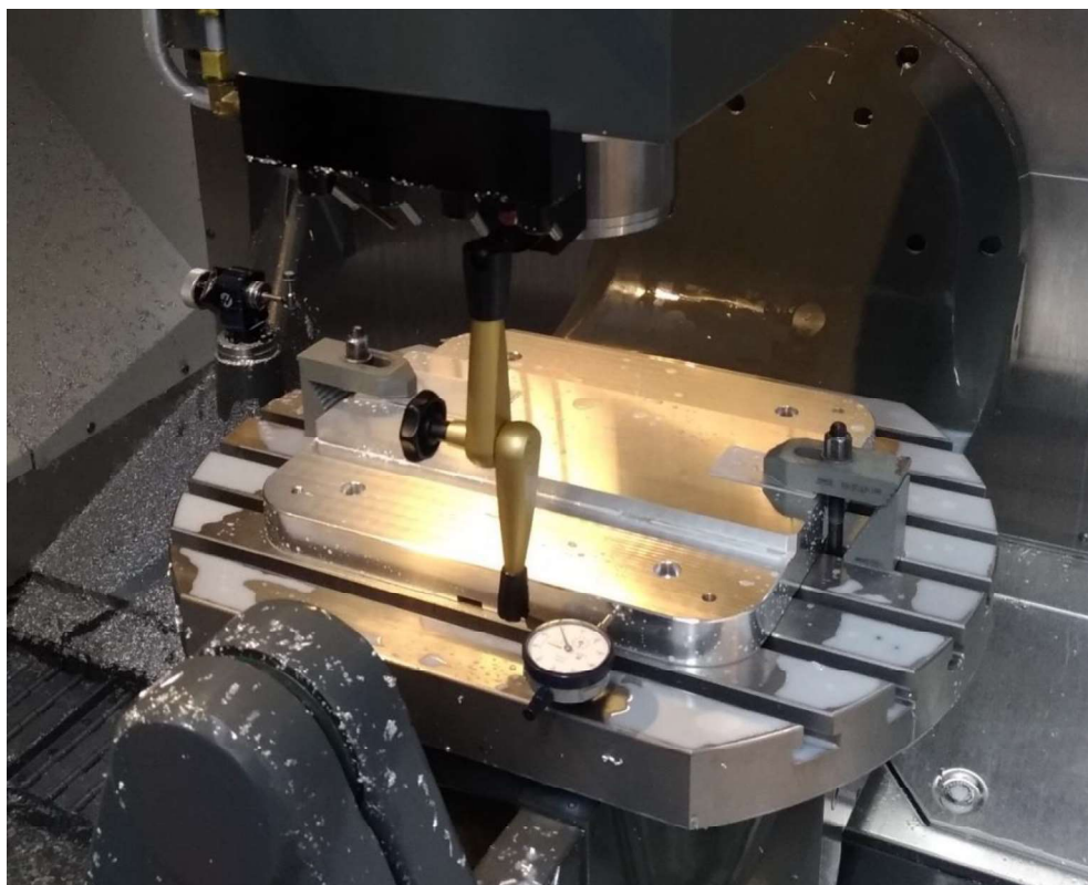
Figura 3.52 - Análise do alinhamento da base com a mesa de trabalho.
