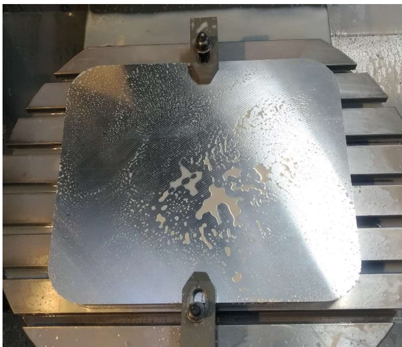
Figura 3.47 - Desbaste dos cantos.
