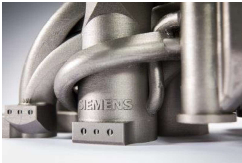
Figura 2.17 - Otimização para produção por adição (Impressão 3D). (Solid Edge, 2019)
