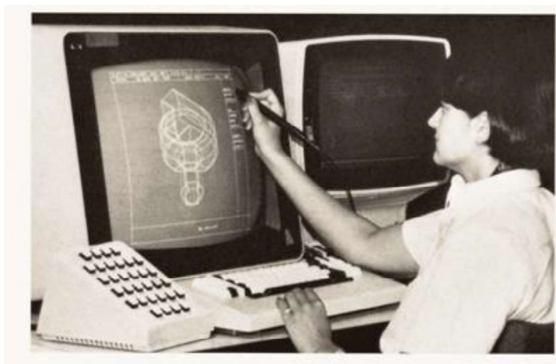
Figura 2.3 - Software de desenho CATIA utilizado em 1981. (Proconcept sistemas, 2018)
