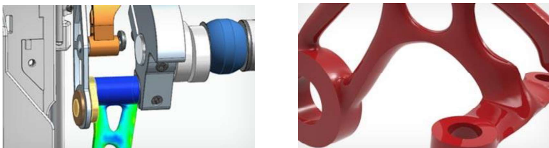
Figura 2.11 - Exemplo de componente antes e após otimização. (Solid Edge, 2019)
