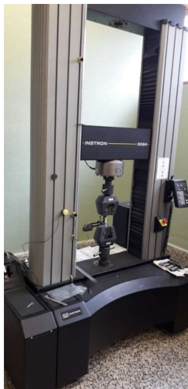
Figura 5.1 - Máquina INSTRON 5584 utilizada nos ensaios.
