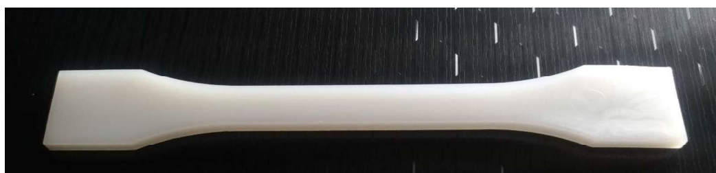
Figura 4.2 - Geometria do Provete produzido por impressão 3D.
