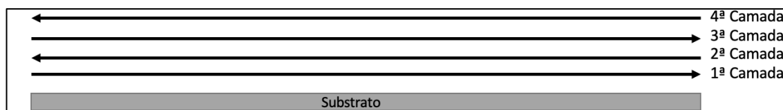
Figura 2.4: Deposição bidirecional do material de adição.
