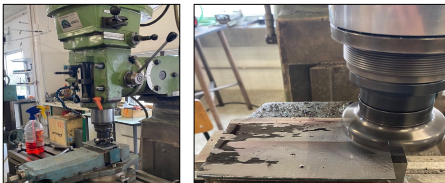
Figura 2.21: Maquinagem da parede.
