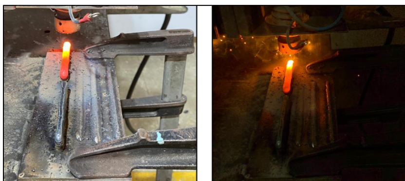
Figura 2.3: Deposição do material de adição na obtenção de paredes de soldadura.
