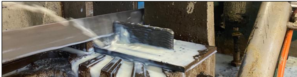
Figura 2.5: Corte das paredes de soldadura.
