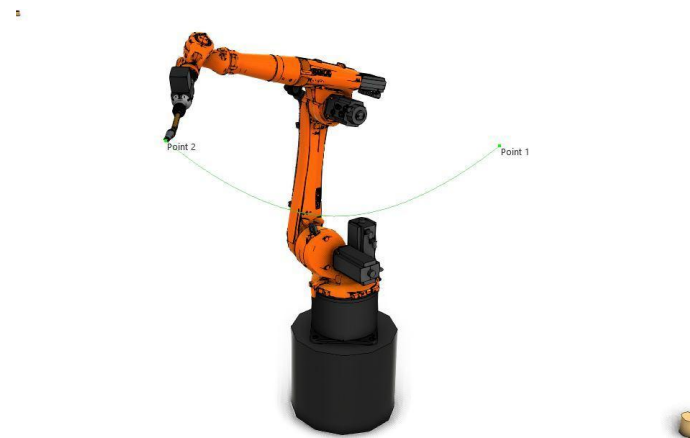
Figura 2.10 Robô a fazer movimento ponto a ponto [17].
