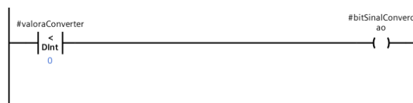
Figura 4.19 Verificação do sinal do valor a converter.
