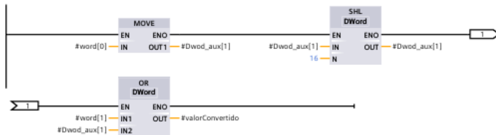
Figura 4.23 Alteração da ordem dos bits das variáveis de 32 bites .
