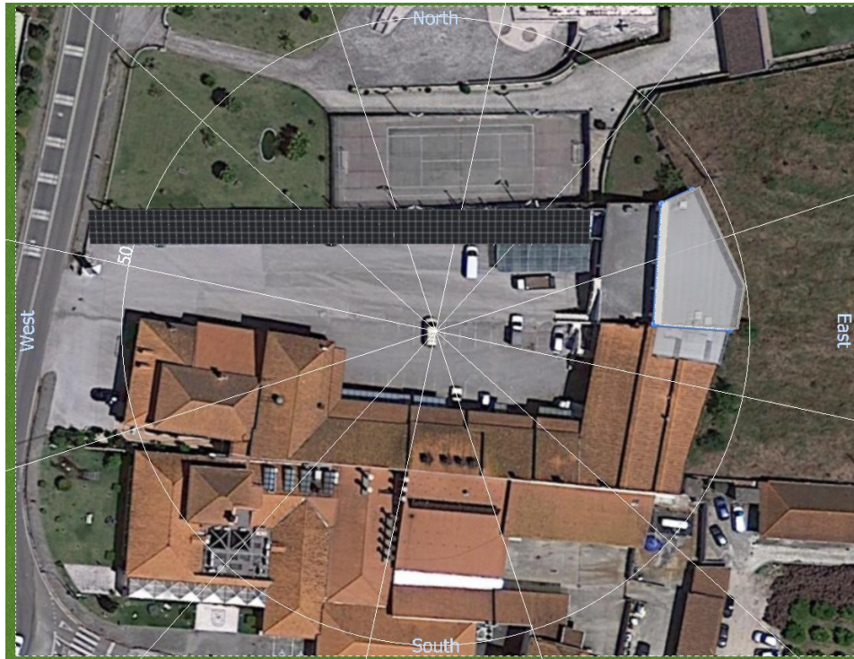
Figura 6.70 - Implementação dos módulos fotovoltaicos no parque de estacionamento do restaurante
