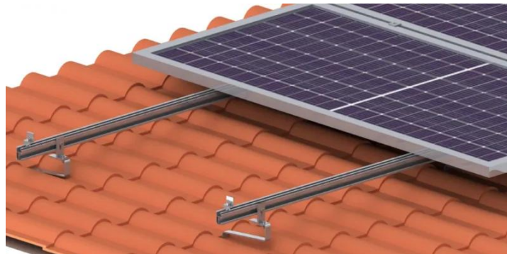
Figura 5.17 - Estrutura de fixação dos painéis fotovoltaicos com recurso a savatela num telhado inclinado [51]
