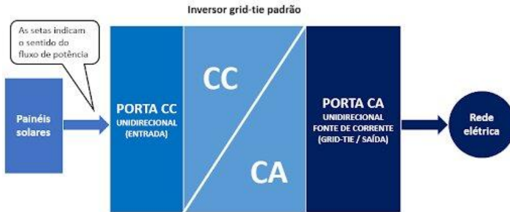
Figura 5.37 – Esquema de um inversor on-grid [58]
