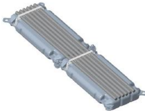
Figura 6.53 - Suporte de cabos Norte-Sul [96]
