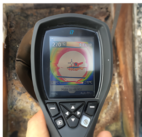
Figura 19 – (A) Medida termográfica da temperatura em um dos locais projetados de monitorização da emissão gasosa; (B) Evolução da temperatura no outro local de monitorização gasosa nas profundidades de 1,3 m (1), 1,4 m (2) e 1,5 m (3) (adaptado de Ribeiro et al. 2017).
