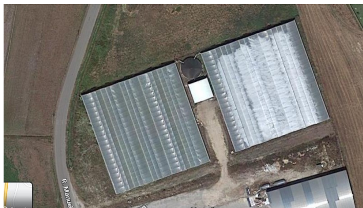
Figura 53 - Tanque com 200 mil litros que aproveita água da chuva para regar a cultura presente nas estufas
