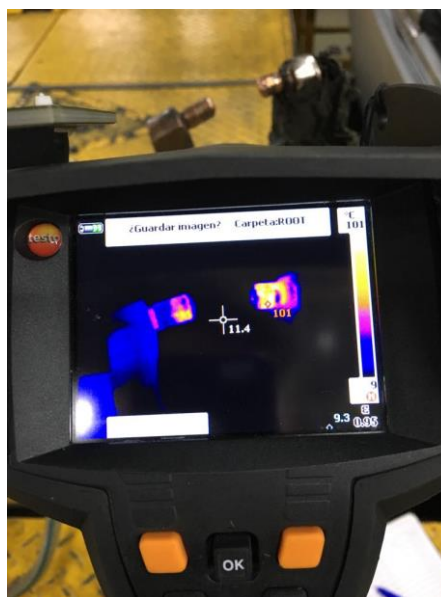
Figura 24 - Exemplo de utilização de câmara termográfica.
