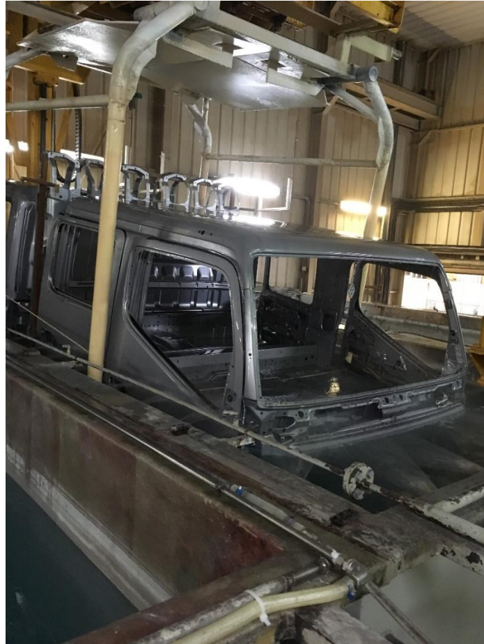
Figura 52 - Hangar a mergulhar as cabines nos tanques de tratamento da chapa.
