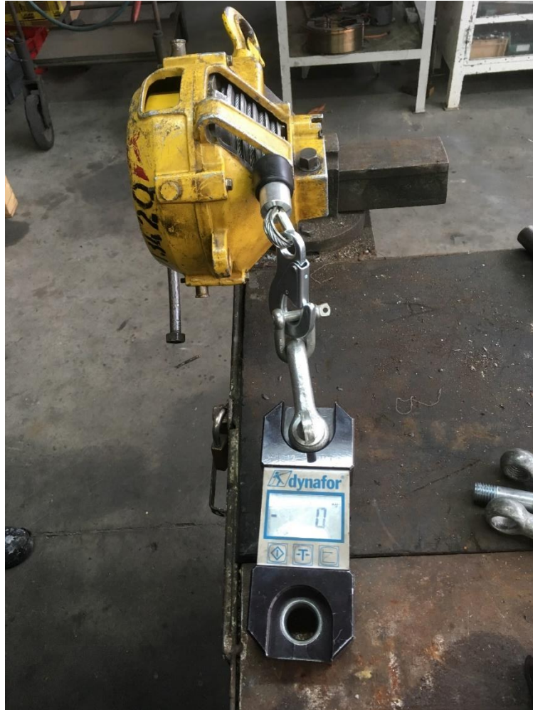
Figura 57 - Calibração do enrolador ou equilibrador.
