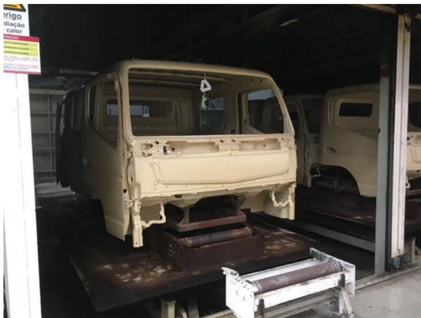
Figura 53 - Cabines depois de fazer o tratamento da chapa, à saída do forno de cozer a tinta.
