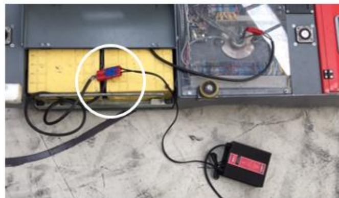
Figura 10 - Ligação da bateria ao carregador
