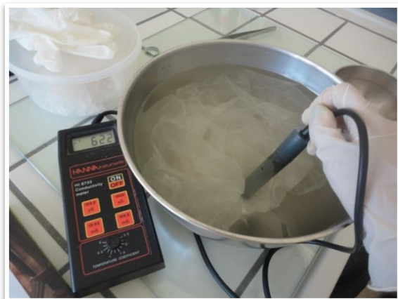
Figura A 62: Leitura de condutividade da solução contendo o agar-agar removido da escultura, com condutivimetro, Santiago.
