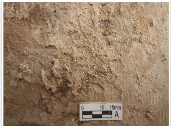
Figura A 13: Cristais de calcite sobre a superfície, brasão.
