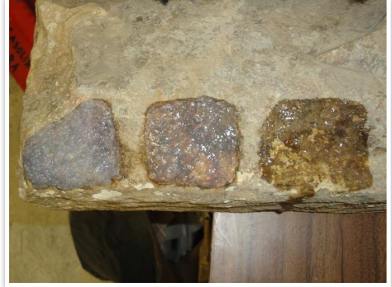
Figura 46: Teste de limpeza com agar-agar: Aplicação de agar-agar (5, 3, 1%)
