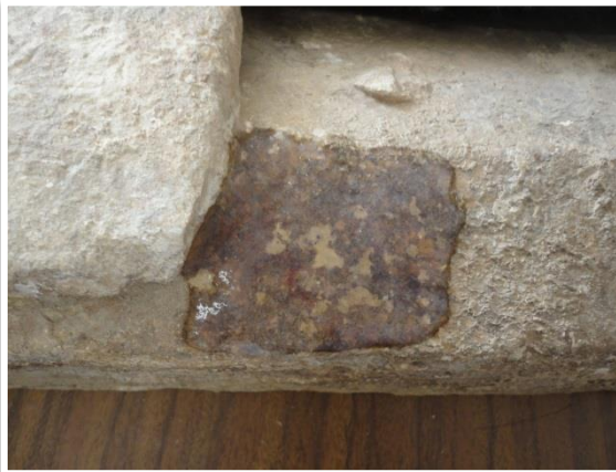
Figura 47: Teste de limpeza com agar-agar: Aplicação de agar-agar a 5% (primeira aplicação)
