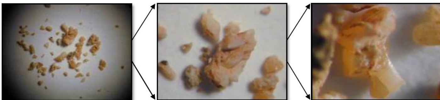
Imagem 7: Observação à lupa binocular de cristais de calcite , provenientes da superfície pétrea – Amostra C1
