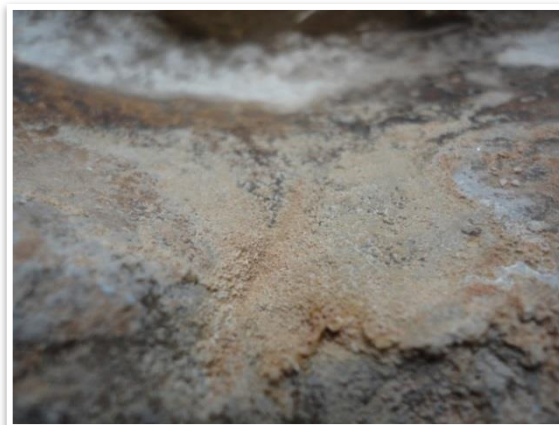
Figura A 9: Cristais de calcite à superfície, brasão.
