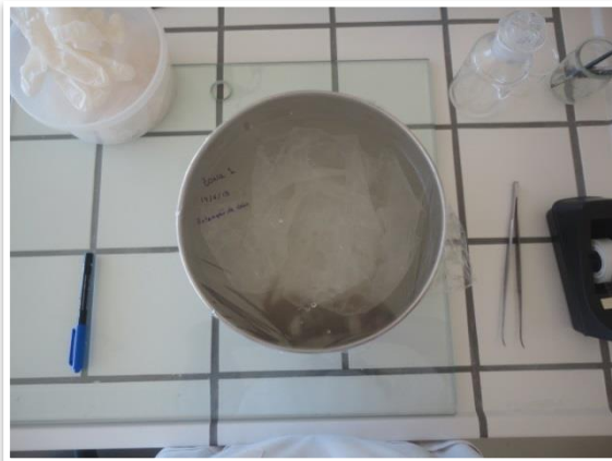
Figura A 66: Solução contendo a película de papel japonês com agar-agar, removida para leitura de condutividade, zona 1, Santiago.
