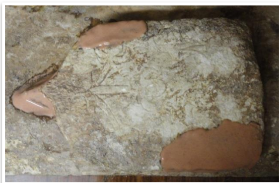
Figura A 32: Limpeza com resina de troca iónica (Amberlite 4400 OH), limpeza pontual, brasão.
