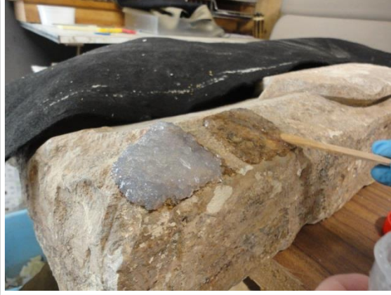
Figura 45: Teste de limpeza com agar-agar: Aplicação de agar-agar (5 e 3%)
