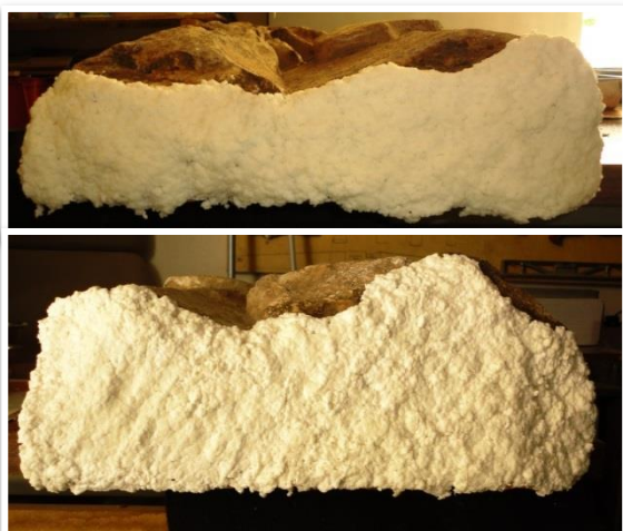
Figura A 17: Limpeza química, com AB57, áreas 2 e 4, brasão.
