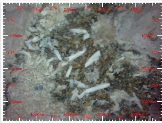
Figura 13: Cristais de calcite sobre a superfície pétreo, registo através de lupa binocular portátil.
