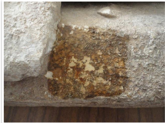
Figura 48: Teste de limpeza com agar-agar, após a remoção da 3ª aplicação de agar-agar a 5%.
