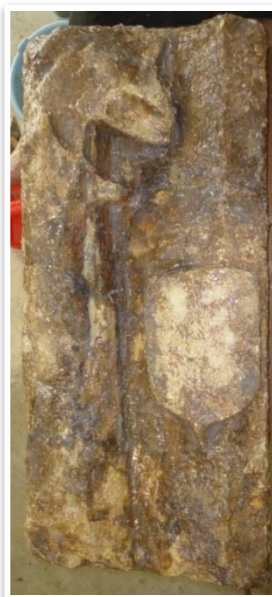
Figura A 21: Limpeza com agar-agar, película sobre a superfície em actuação, brasão.
