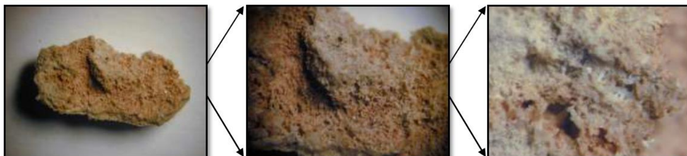
Imagem 7: Observação à lupa binocular do interior da concreção calcária , que estava em contacto com superfície pétrea, apresentando cristais de calcite – Amostra A1
