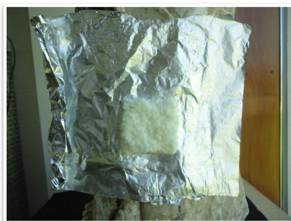
Figura 54: Esquema usado para aplicação de pasta de papel numa janela de 6 cm 2 (amostra 1)
