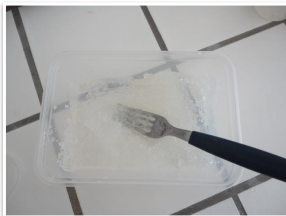
Figura A 70: Melhoramento da consistência de agar-agar, com pré trituração com um garfo, Santiago.
