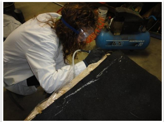
Figura A 15: Desbaste com micro-martelo-pneumático, brasão.
