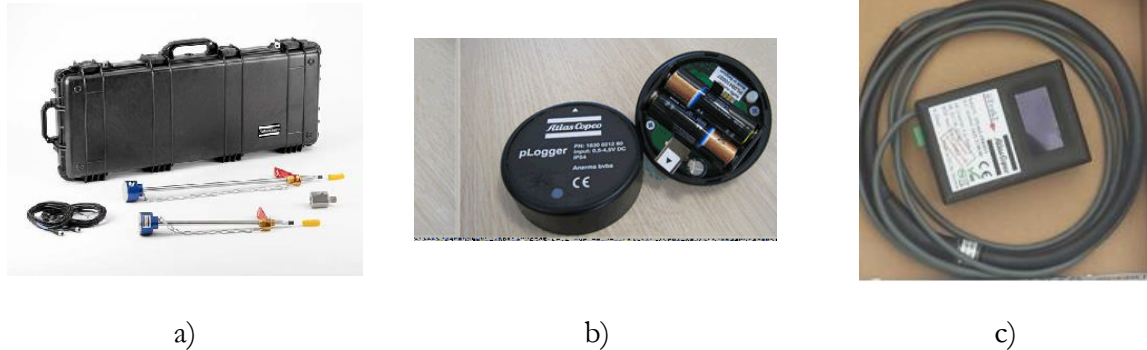
Figura 3.8 – Aparelhos: a) Caudalímetro; b) Registo de Pressão; c) Registo corrente
