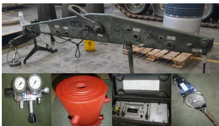
Figura 6 - Exemplo de ferramentas pertencentes ao conjunto de ferramentas especiais de casco e de torre dos CC Leopard 2 A6;
