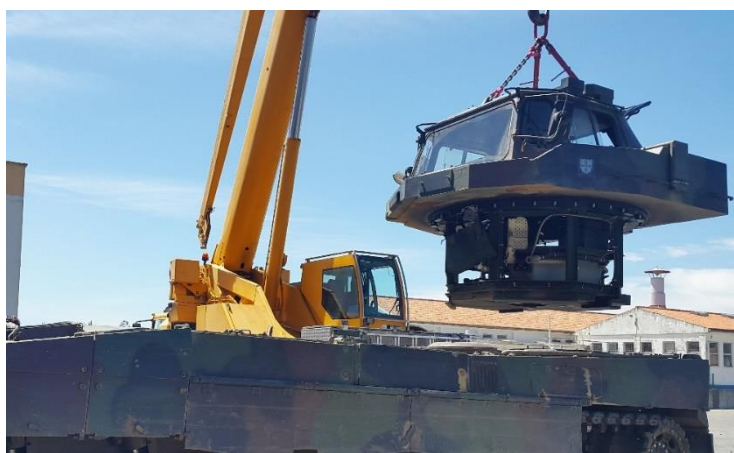
Figura 8- Remoção da torre de instrução de um CC Leopard 2 A6 Buggy, por meio civil;
