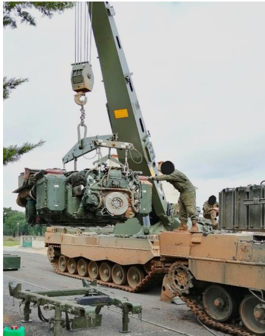
Figura 10 - Intervenção no Power Pack de um CC pela viatura Bergerpanzer Buffel do Exército Espanhol;
