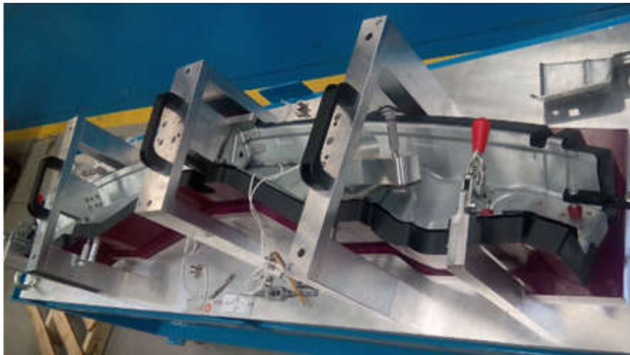
Figura 40 - Gabarito de controlo de um conjunto soldado.
