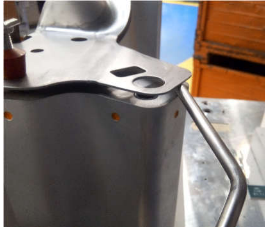
Figura 35 - Calibre de tolerância de corte.
