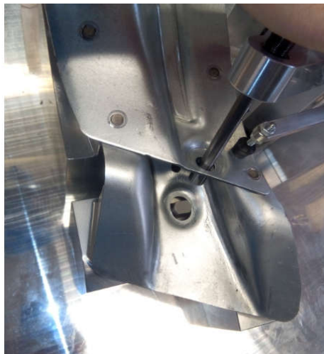
Figura 34 - Calibre de dimensão e posição de furo.
