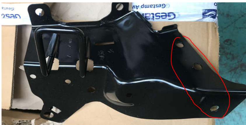
Figura 38 - Peça não conforme, ausência de furo.
