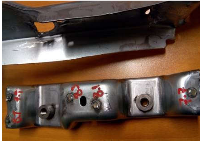
Figura 41 - Ensaio destrutivo de soldadura.
