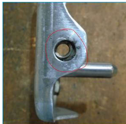
Figura 42 - Conjunto soldado não conforme porca M6 descentrada.
