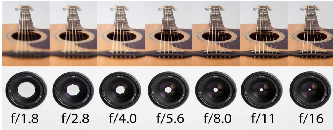
Figura 6. Exemplicação da profundidade de fundo em relação com a abertura do diafragma.
