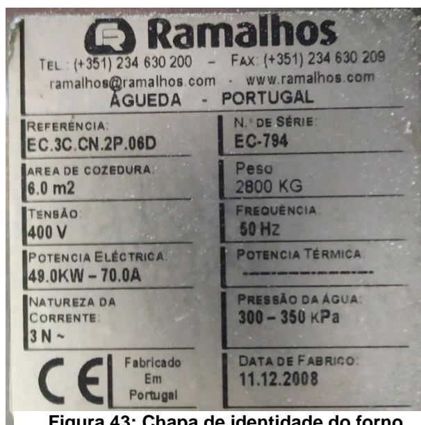
Figura 43: Chapa de identidade do forno elétrico
