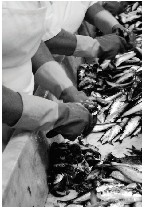
18 Conserveira Pinhais, 2014. Quando o peixe chega à fábrica este é transportado e depositado nas bancas de mármore. De seguida, procedesse ao descabeço e evisceração do mesmo.
