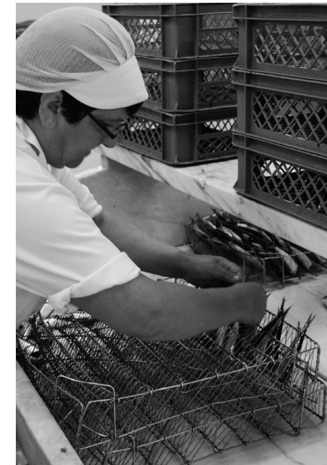
19 Conserveira Pinhais, 2014. O peixe é colocado em tanques de salmoura, onde é dessangrado e adquire paladar. Após algum tempo em repouso é de seguida engrelhado.
