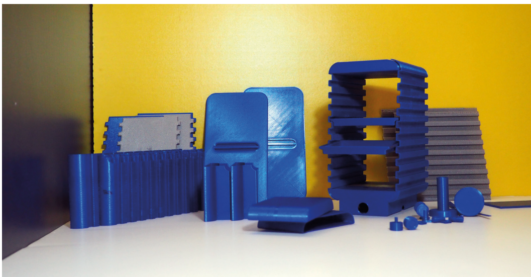
Figura 61. Algumas das peças impressas para a verificação das formas e proporções. Fonte: Autor
