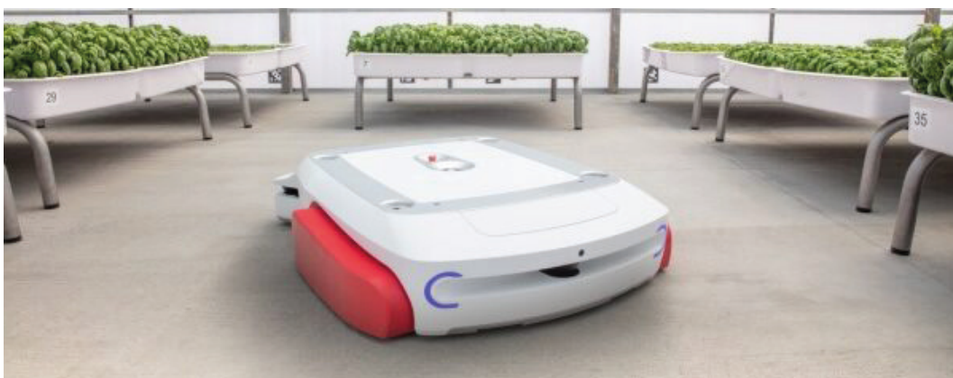
Figura 29. Segundo, e mais recente, robô de transporte autônomo de tabuleiros de cultivo, desenvolvido pela IronOx. Fonte: https://ironox.com/
