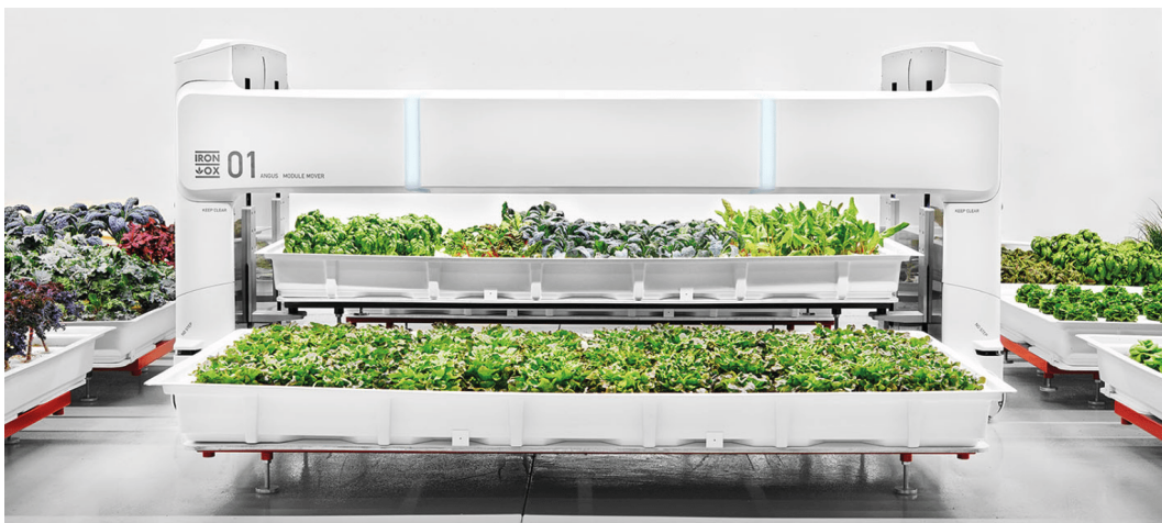
Figura 28. Primeiro robô de transporte autônomo de tabuleiros de cultivo, desenvolvido pela IronOx. Fonte: https://ironox.com/
