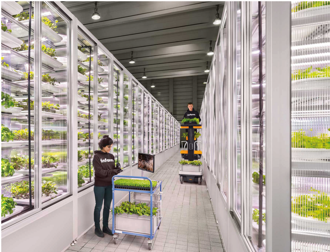
Figura 24. Detalhe dois do sistema de produção em massa da Infarm. Fonte: https://www.infarm.com/
