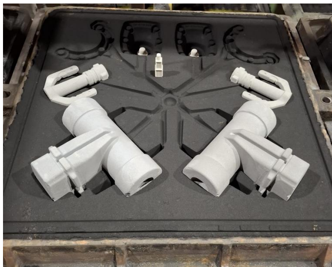
Figura 2.6 - Caixa de moldação com machos para formar cavidades internas nas peças
