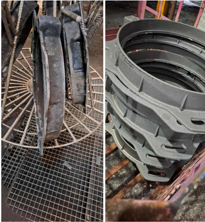
Figura 2.13 - a) Peças antes do processo de granalhagem b) Peças após o processo de granalhagem
