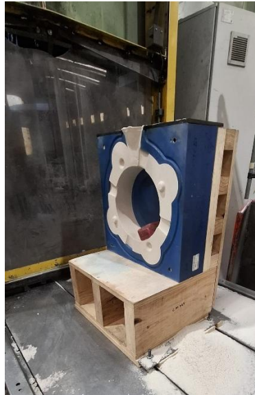
Figura 2.8 - Produção de machos na caixa de moldação
