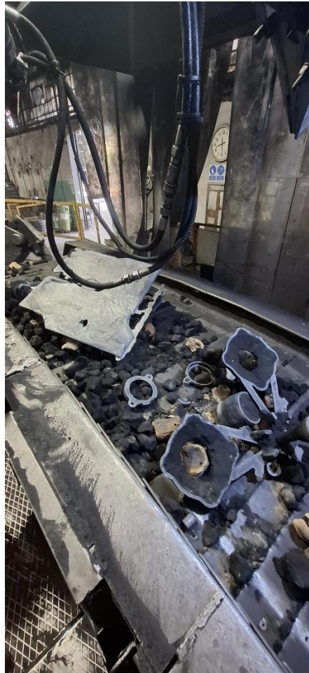
Figura 4.14 - Tapete metálico após desmoldamento
