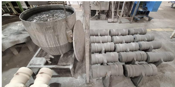
Figura 2.9 - Macho revestido com base aquosa
