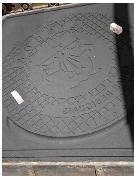
Figura 2.7 - Machos utilizado para formar zonas ocas de encaixe na tampa
