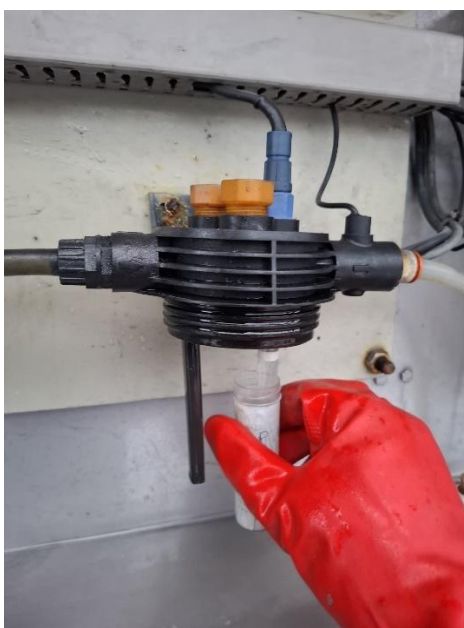
Figura 4.32 - Calibração da sonda de pH
