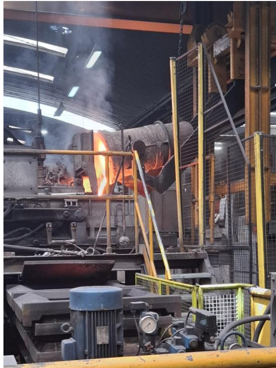
Figura 4.12 - Colher de vazamento automático (Tundish)
