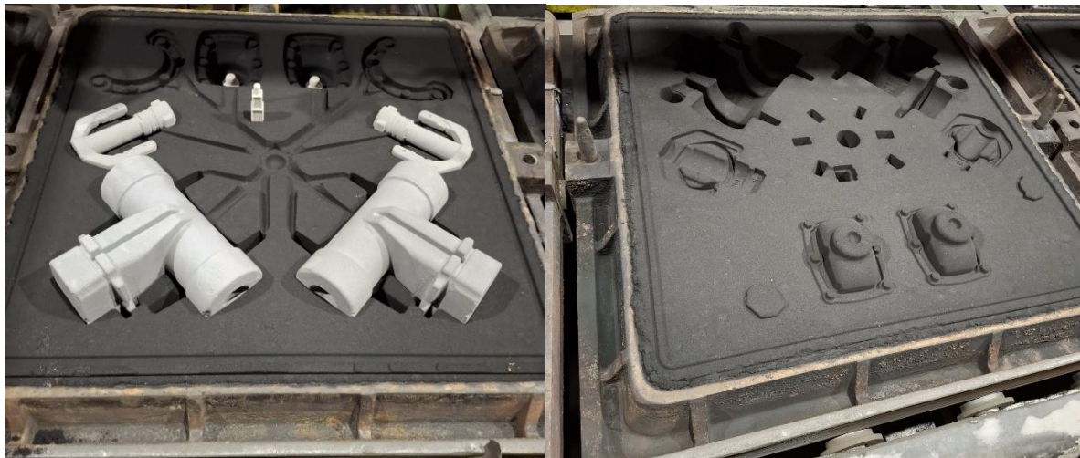
Figura 2.10 - Caixa de moldação inferior e superior respetivamente
