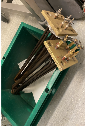
Figura 4.3: Resistências do Gerador de Vapor.
