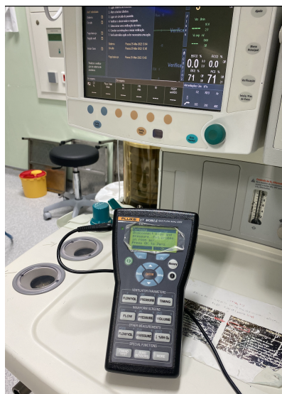
Figura 2.6: Equipamento de Teste de Ventilador (Marca: Fluke e Modelo: VT Mobile).
