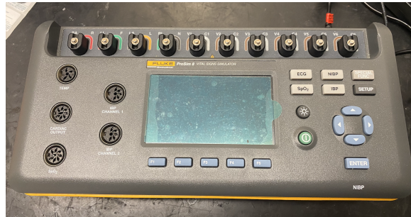
Figura 2.8: Simulador de Sinais Vitais (Marca: Fluke e Modelo: PromSim 8).
