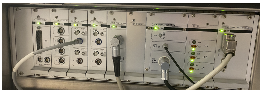
Figura 3.16: Módulos de Controlo dos Sensores e dos Conversores.
