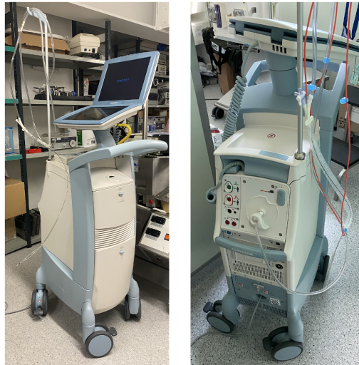
Figura 3.3: Balão Intra-Aórtico (Marca: Maquet e Modelo: Datascope C300).
