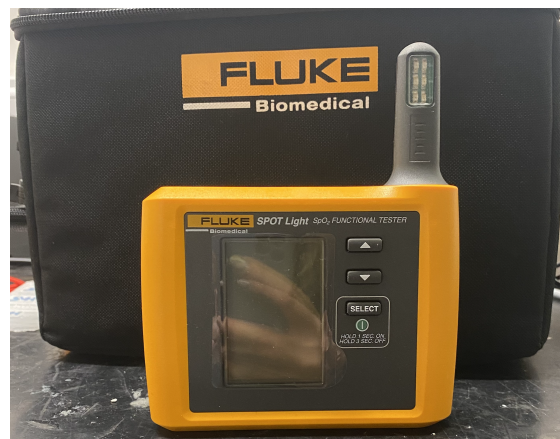
Figura 2.9: Simulador de Saturação Periférica de Oxigénio (Marca: Fluke e Modelo: ProSim SPOT Light SpO 2 ).
