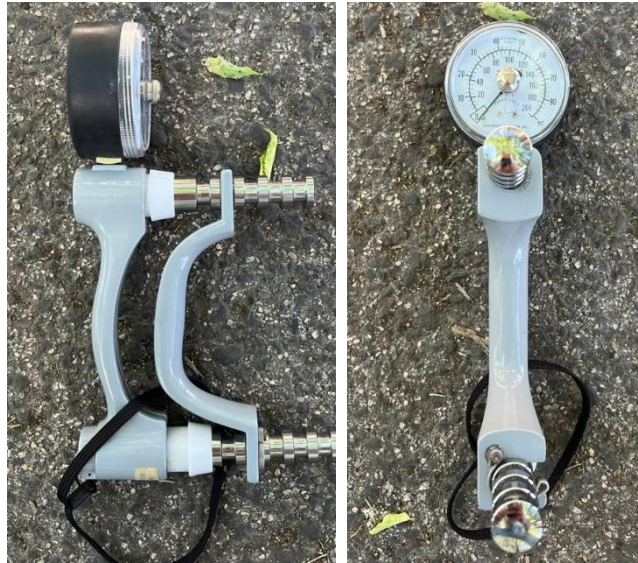
Figura 17. Dinamómetro de preensão manual Hidráulico - Jamar ® (Hydraulic Hand Dynamometer (Model J00105) (Sammons Preston, Bolingbrook, Illinois)
