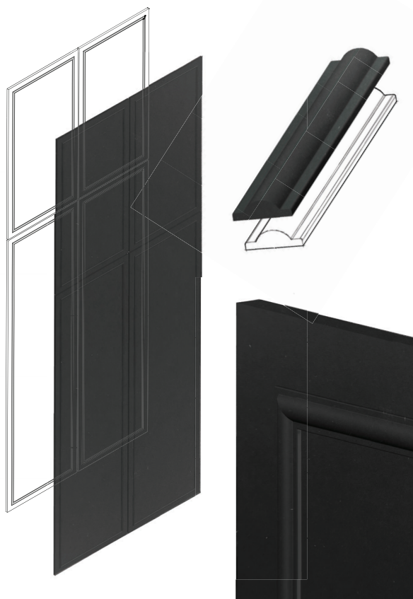
Figura 159. Fotomontagem de modelo tridimensional - painéis que revestem as paredes da área engage .
