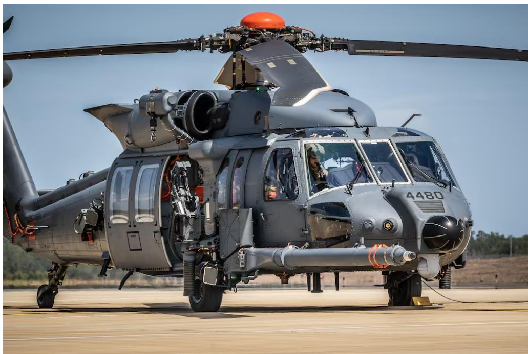
Figura 3 Imagem de um Sikorsky HH-60W Jolly Green II da USAF, onde é possível visualizar o armamento, o guincho, e o sistema de abastecimento em voo. Fonte: USAF/Defense News ( https://www.defensenews.com/air/2022/03/31/us-air-forces-new-jolly-green-ii-combat-rescue-helicopter-begins-operational-testing/ )
