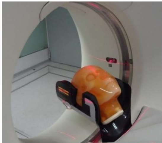
Figura 17 – Posicionamento do fantoma na realização dos testes experimentais para TC CE
