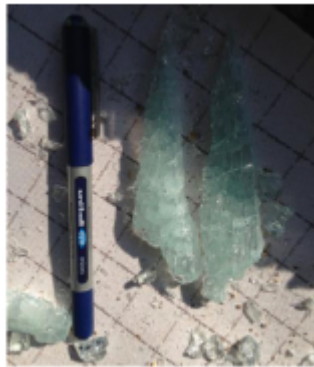
Figura 3.5: Padrão de rotura do vidro temperado (adaptado de [31])
