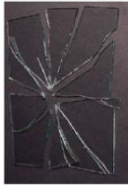
Figura 3.2: Padrão de rotura do vidro recozido (adaptado de [31])
