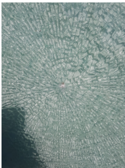
Figura 5.13: Ponto de convergência das fissuras obtidas no ensaio a 12 metros
