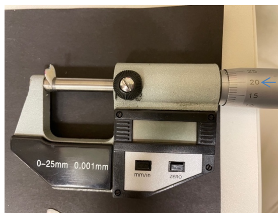
Figura 16. Medição da espessura da amostra com recurso a cravira.
