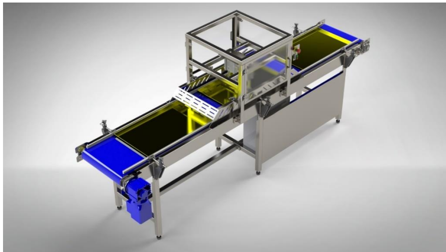
Figura 31 – Vista em perspetiva frontal do projeto final da máquina de corte de barras energéticas
