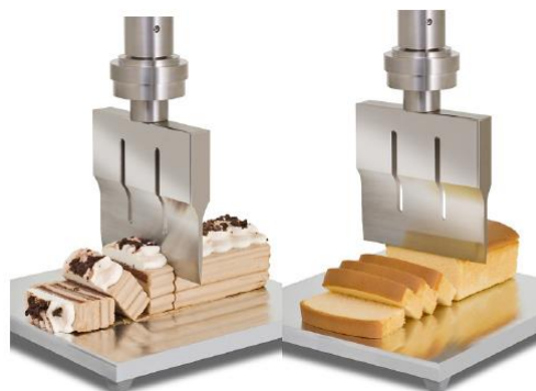
Figura 4 - Corte ultrassónico de diferentes produtos. Adaptada de [7]
