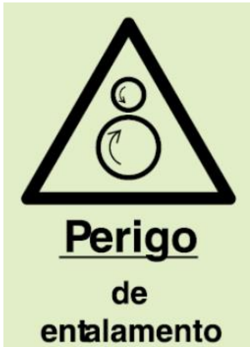
Figura 48 - Sinalização de perigo de entalamento.
