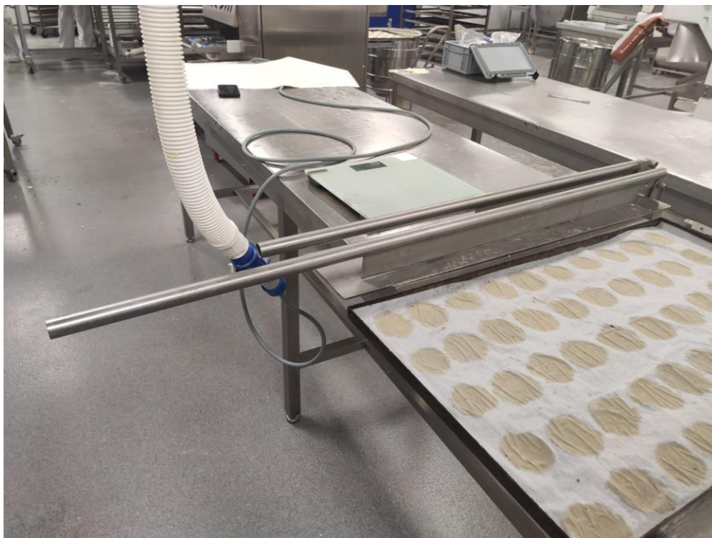
Figura 7 - Equipamento de corte manual de barras energéticas
