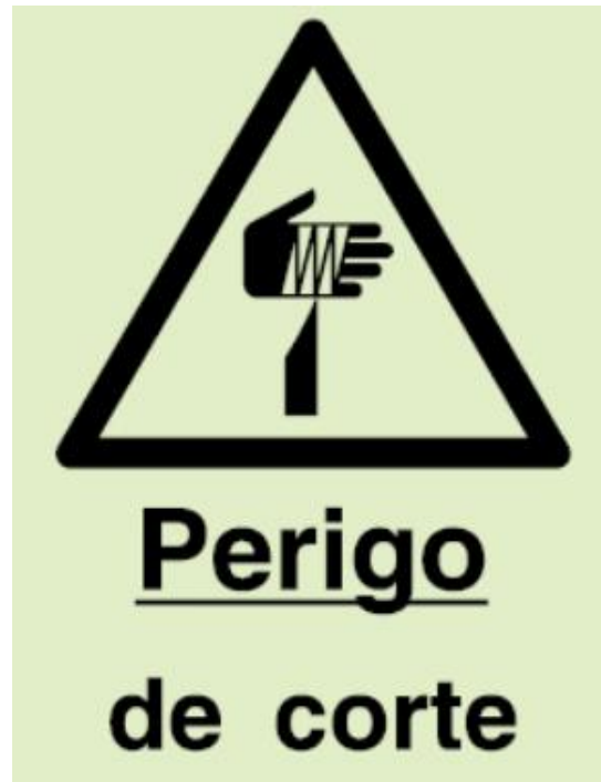
Figura 49 - Sinalização de perigo de corte.
