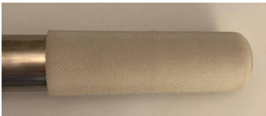
Figura 3.5 - Resultado final da pega já colocada no braço.
