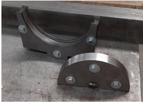
Figura 55 – Matriz e Punção (1º protótipo)
