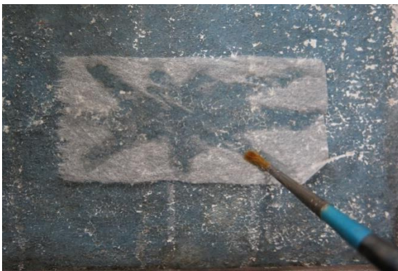
Fig. 80 – Aplicação do adesivo sobre o papel japonês | A.P.
