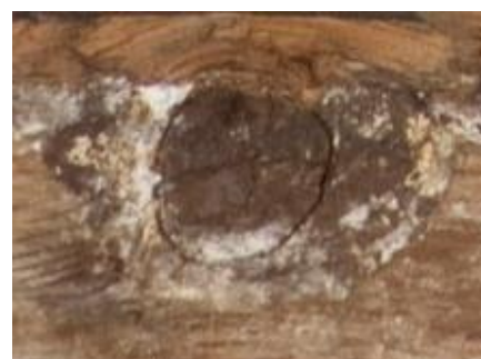
Fig. 54 - Nó (defeito característico do tipo de madeira de pinho) na tábuia inferior da moldura, visível através do verso | C.F.: Gonçalo Figueiredo (LabFoto do Lab.IPT)
