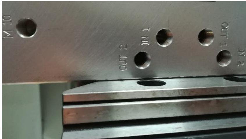
Figura 5.25 – Resultado da operação de gravação dos M10 dos olhais e nomenclatura de identificação do dos circuitos das águas do molde
