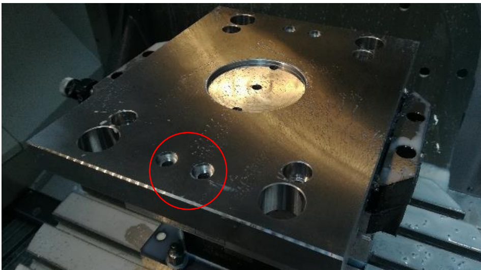
Figura 5.22 - Resultado das etapas de maquinagem na chapa n.º 9.
