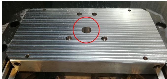
Figura 5.13 – Resultado após maquinagem da furação das águas e do furo H7/g6 para o bico de injeção.
