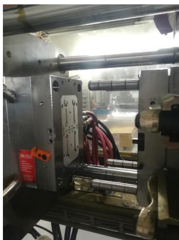
Figura 6.3 - Teste do curso de extração e abertura do molde.
