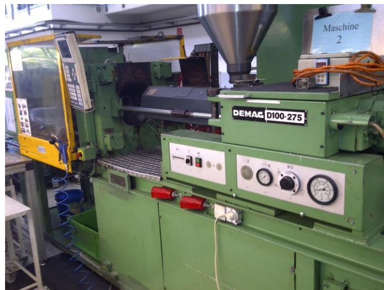
Figura 3.2 - Máquina de injeção Demag D 100 - 275 NCIII.
