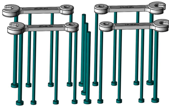
Figura 4.45 - Visualização da posição dos extratores nas peças.
