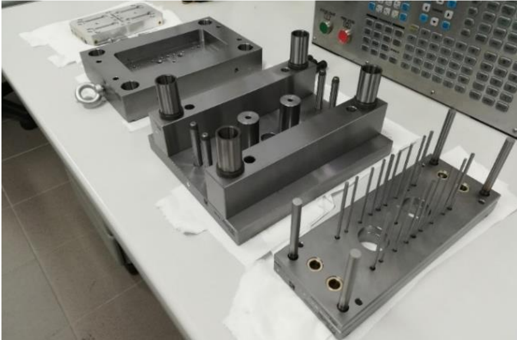
Figura 5.30 - Montagem dos elementos na parte da extração do molde.
