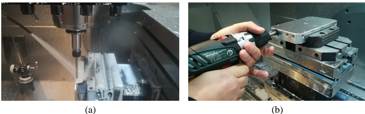
Figura 5.11 – Furação das águas laterais (a) e chanfro dos furos laterais (b).
