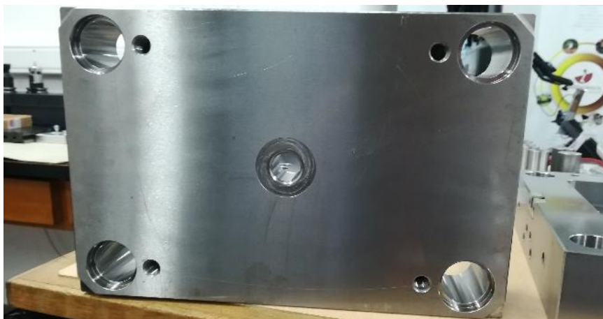
Figura 5.26 - Resultado da operação de maquinagem de uma caixa circular para rebaixamento do bico de injeção.
