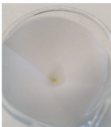
Figura A7- Branco do teste colorimétrico Fast Blue BB, feito com lúpulo. Pode ser observado que não ocorreu reação, não apresentando cor.
