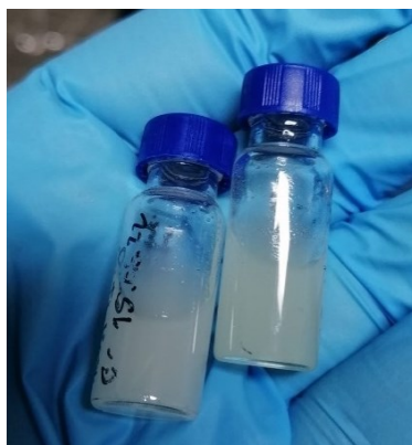
Figura 18- Amostra de óleo de canábis em metanol, após vórtex e banho de ultrassons, em duplicado.
