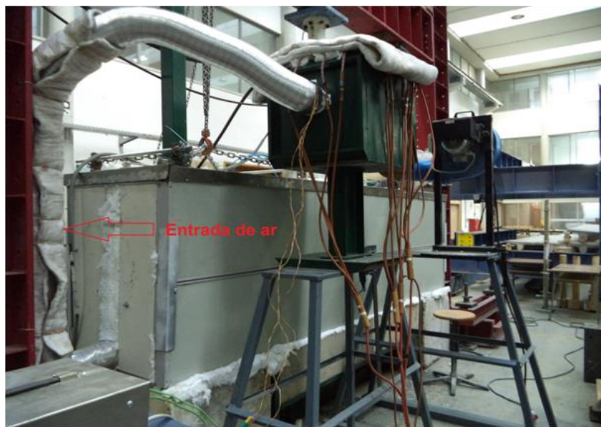
Fig. 71 – Câmara climática com entrada de ar na vertical.
