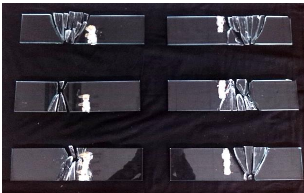
Fig. 92 - Padrões de ruptura dos diferentes provetes.
