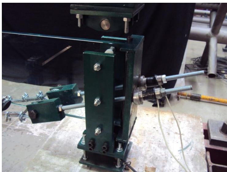
Fig. 113 – Sistema de ancoragem e sistema de medição de forças no cabo.
