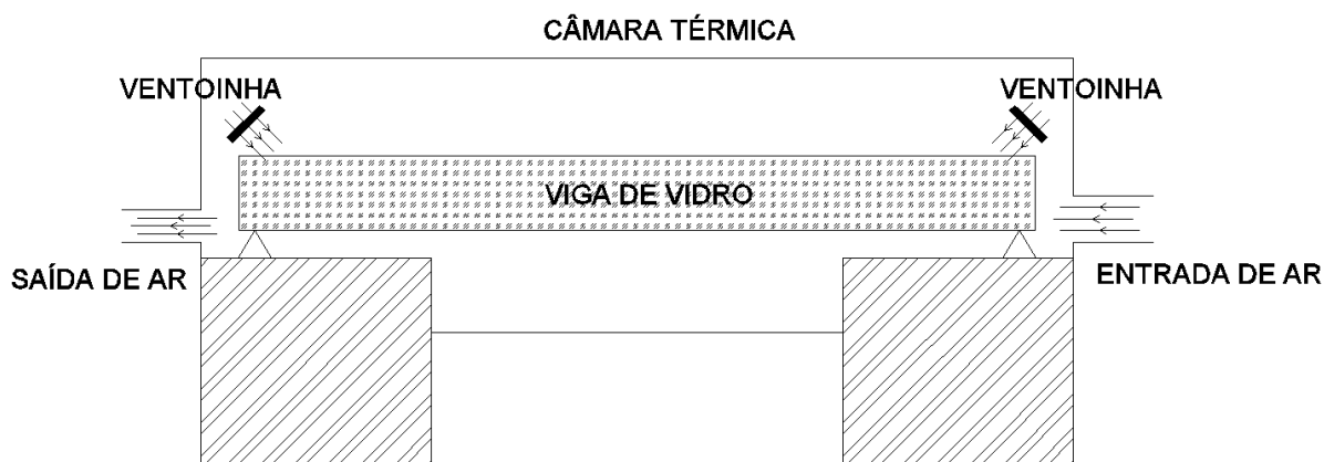
Fig. 75 – Esquematização da posição das ventoinhas.
