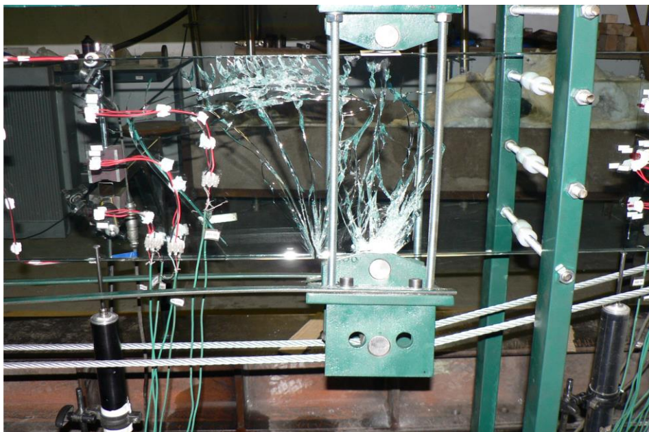
Fig. 121 - Provete após ensaio com cabo de pré-esforço.
