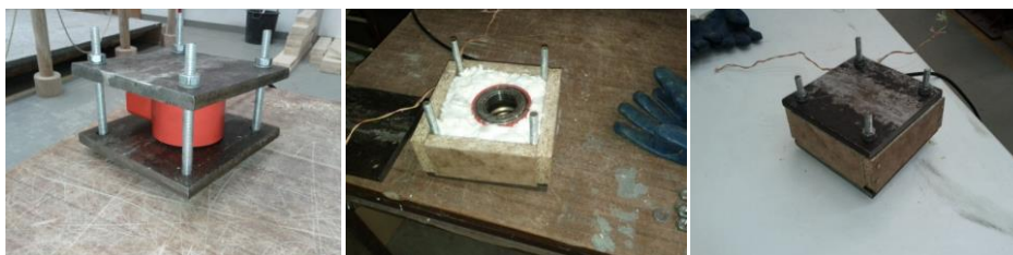
Fig. 54 - Preparação da caixa de isolamento para célula de carga.
