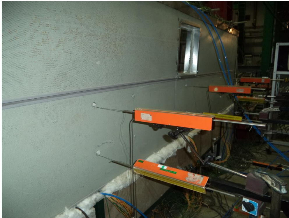
Fig. 131 – Pormenor dos deflectómetros fora da câmara térmica.
