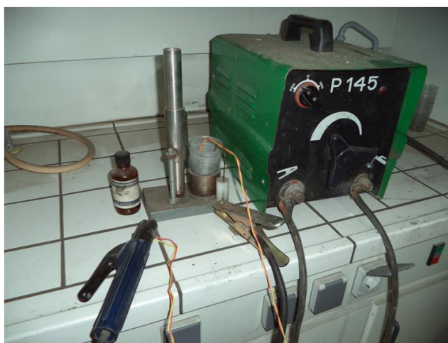
Fig. 24 - Soldadura por arco eléctrico.
