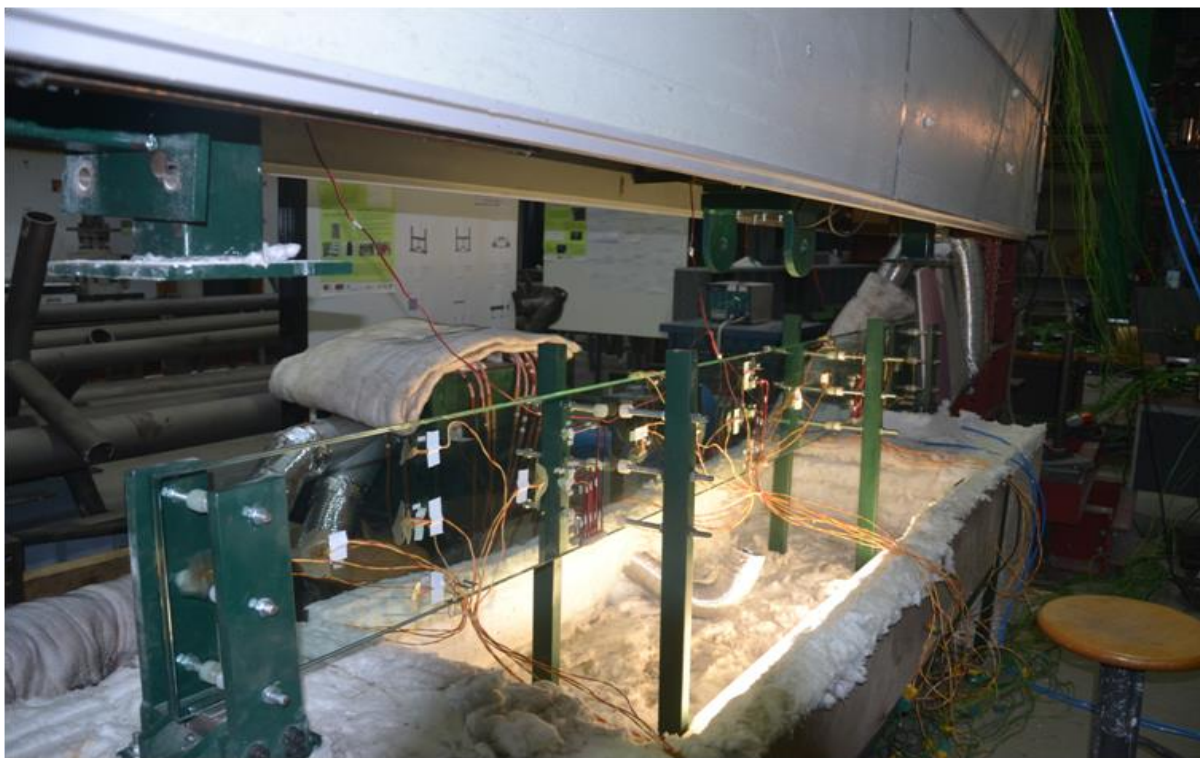
Fig. 80 - Provede de vidro laminado com SentryGlass instrumentado com termopares
