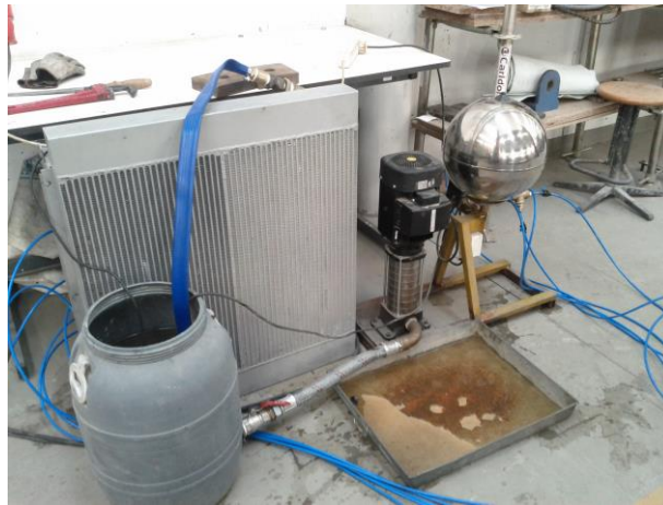
Fig. 68 - Equipamento para circulação de água na refrigeração das células de carga.
