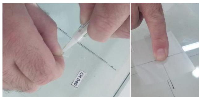
Fig. 14 – Procedimento de colagem do extensómetro.
