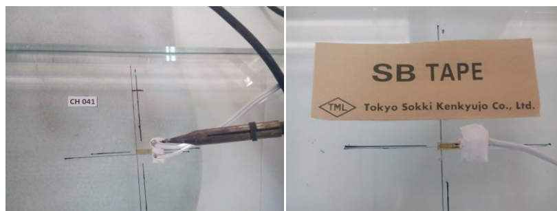
Fig. 15 – Estanagem e ligação dos extensómetros.
