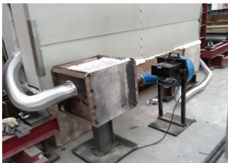
Fig. 52 - Sistema de circulação e aquecimento do ar.
