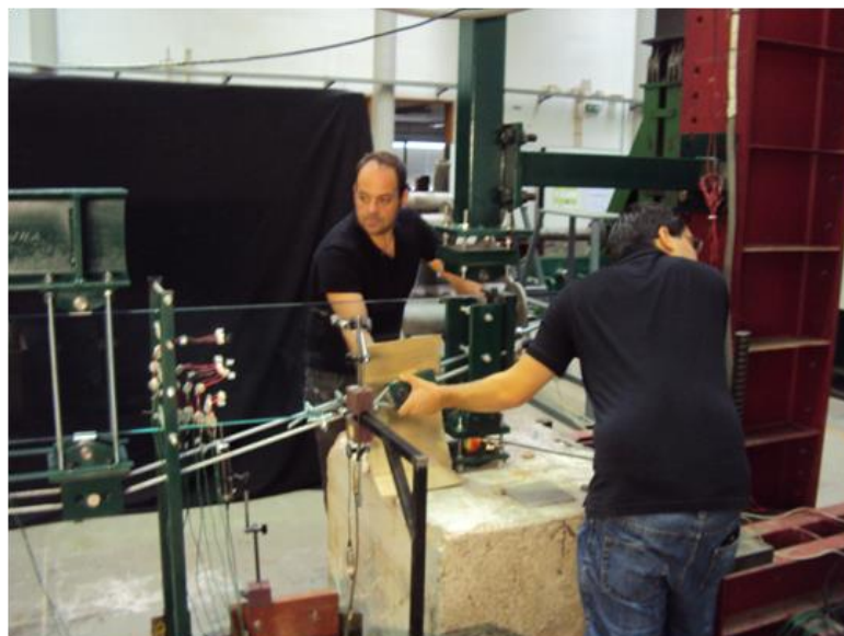
Fig. 114 – Processo de aplicação do pré-esforço.
