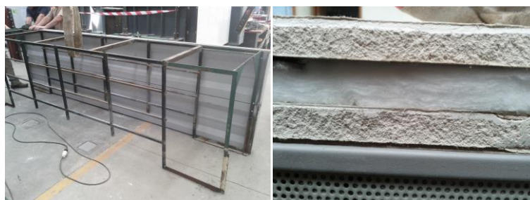
Fig. 49 - Pormenores de construção da câmara térmica.
