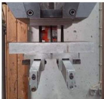
Fig. 94 - 2º layout de teste de caracterização do vidro.
