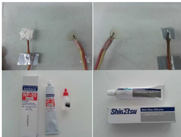
Fig. 25 – Termopares aplicados no vidro e respectivos adesivos. (Rolo, 2013)
