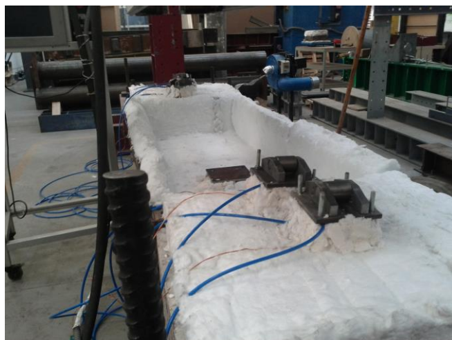
Fig. 65 - Foto do sistema para refrigerar e isolar as células de carga.
