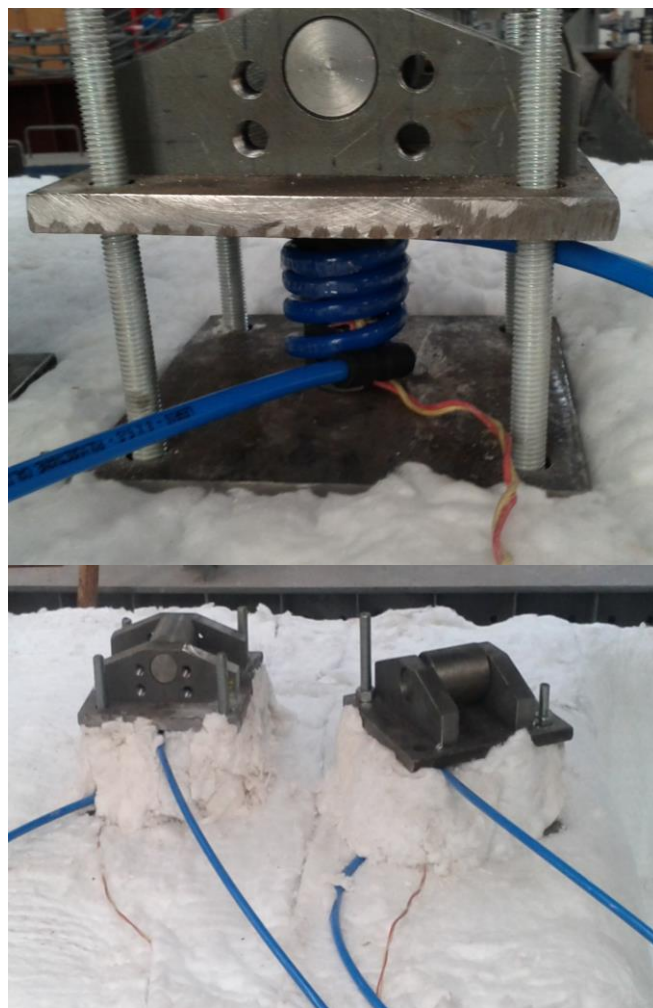
Fig. 63 - Preparação do sistema de refrigeração e termopar para as células de carga.
