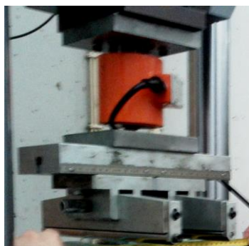
Fig. 95 - 3º layout de teste de caracterização do vidro.
