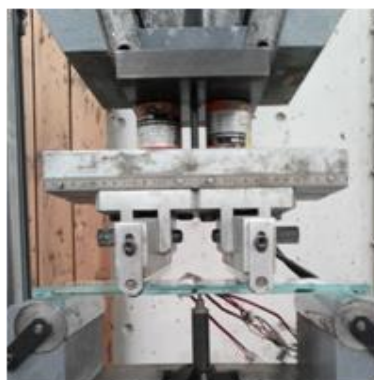
Fig. 93 - 1º layout de teste de caracterização do vidro.
