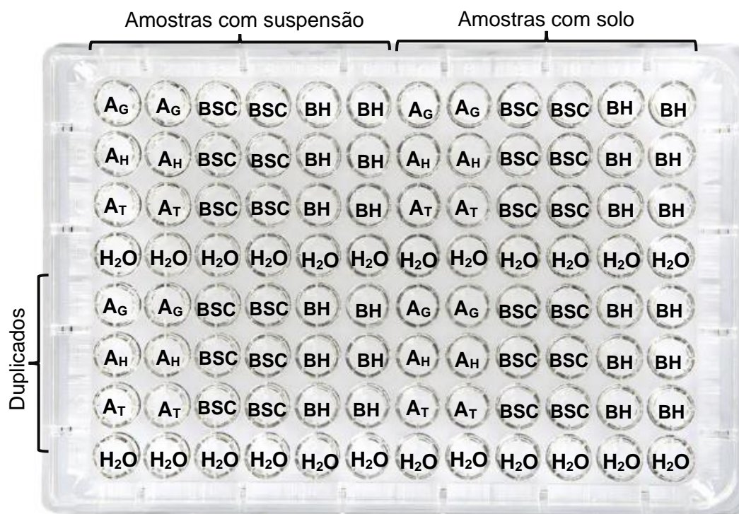
Figura 13: Distribuição das amostras pela microplaca, no estudo a biodegradabilidade (adaptado Direct Industry, 2022).
