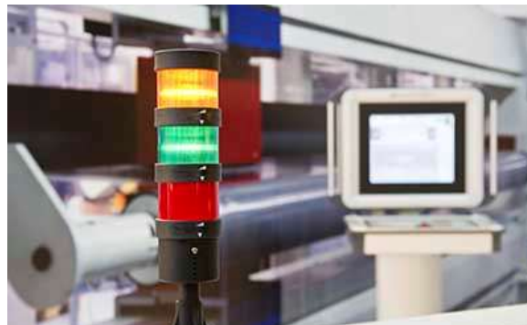
Figura 12 Sistema de iluminação tradicional do Andon
