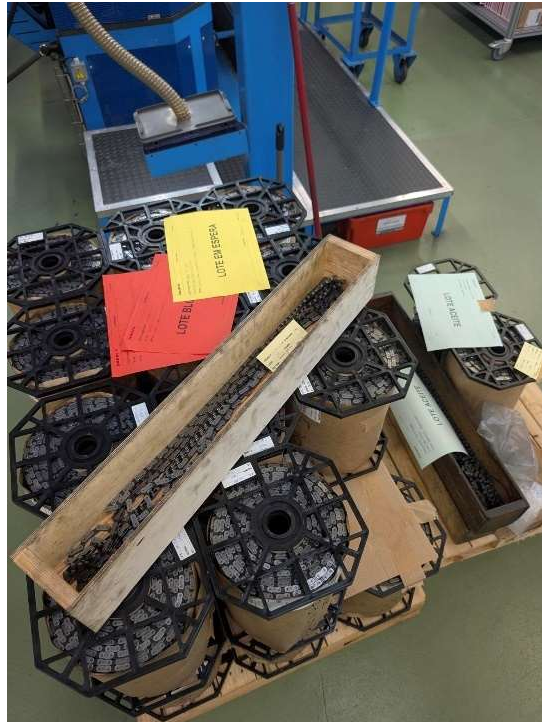
Figura 18 Ilustração gráfica de problema: Paletes com material não conforme junto com material conforme e material a aguardar decisão
