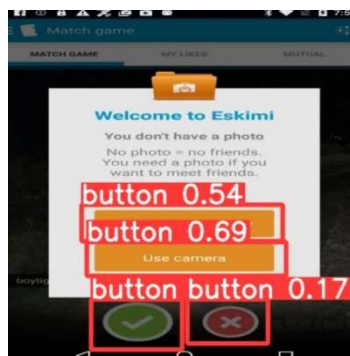
Figura 26- Resultado da detecção de objetos feita pelo algoritmo YOLOv5 para o projeto CognitiveQA
