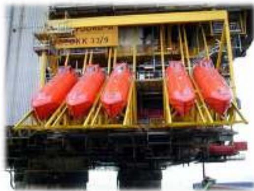
Figura 2.8: Salva-vidas free-fall da Statfjord A (extraído de [35])
