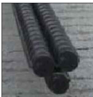
Figura 3.5.8 - Sistema pré-fabricado - varões CFRP (Juvandes, 2011)
