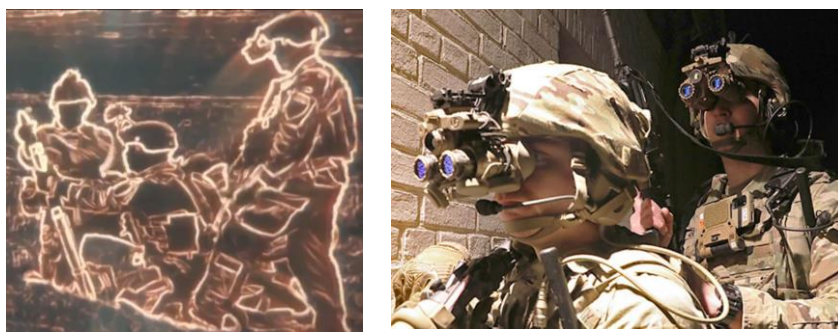
Figura 6 – Imagem e utilização do protótipo ENVG-B Fonte: Disponível em US Army (2019a); Wetsman (2021).
