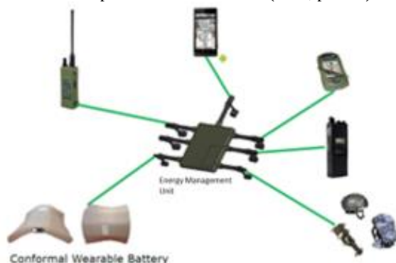
Figura 8 – Protótipo de sistema de gestão de energia com baterias leves e ajustáveis ao corpo Fonte: Disponível em NATO STO (2018, p. 2-37).
