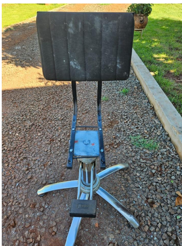
Figura 36 - Instalação do assento da cadeira na base hidráulica
