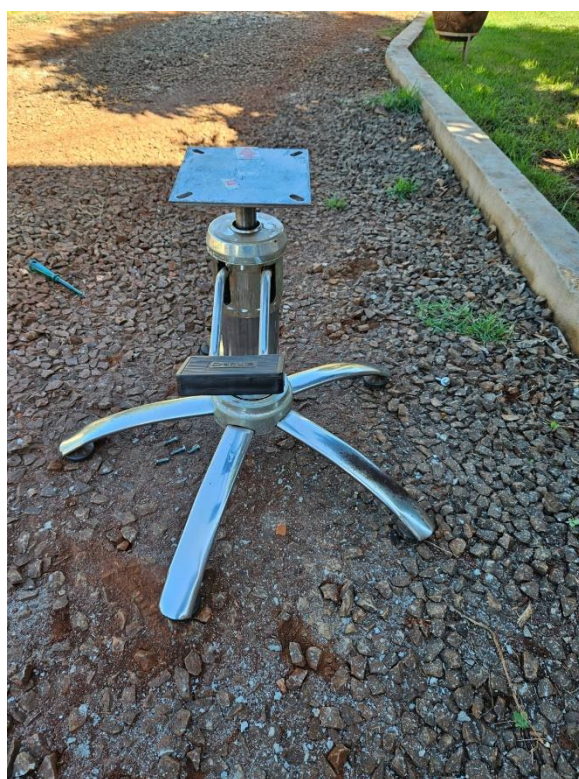
Figura 35 - Base com o sistema de elevação hidráulica
