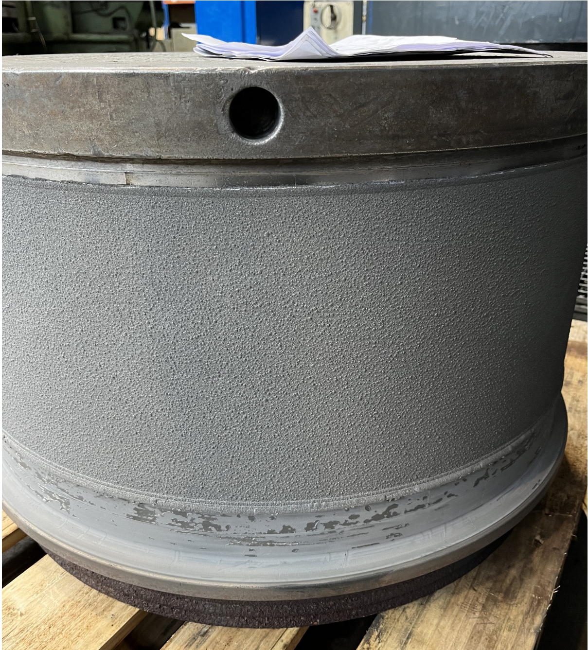
Figura 4.29: Bobina após remoção da aba e novo revestimento
