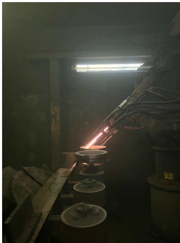
Figura 3.6: Sistema de projeção por HVOF em operação
