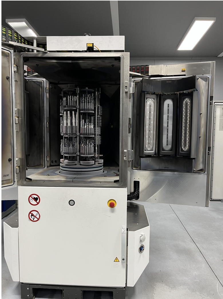
Figura 3.12: Câmara de revestimento por deposição física de vapor
