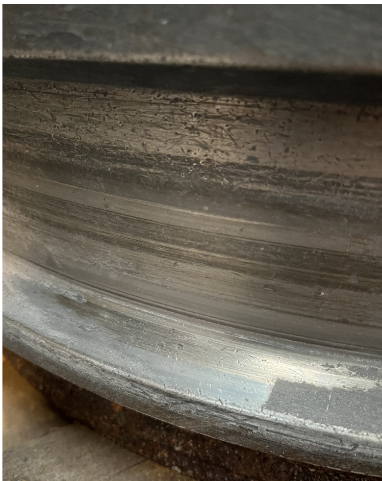
Figura 4.25: Fissuras na zona revestida da bobina
