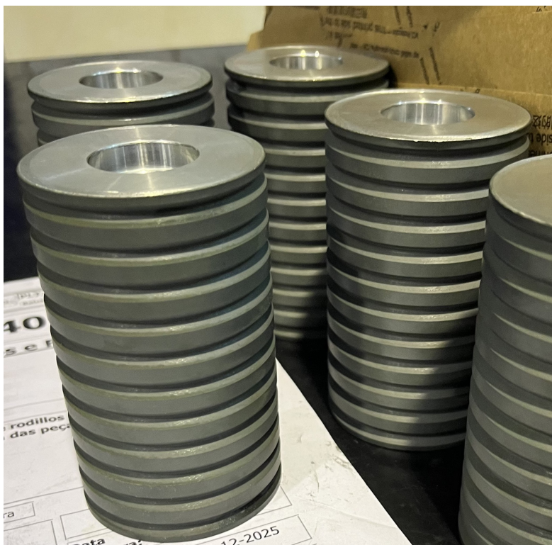
Figura 4.11: Aspeto final dos componentes após conclusão do revestimento
