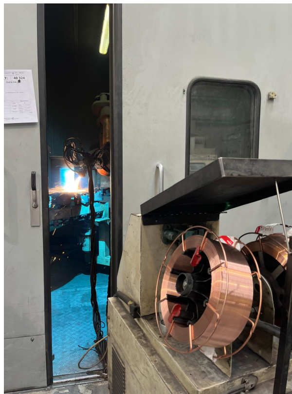
Figura 3.9: Sistema de projeção por EAWS em operação
