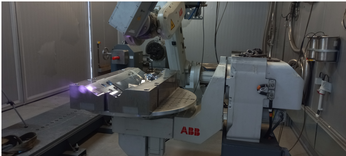
Figura 3.19: Sistema de Laser Hardening em operação
